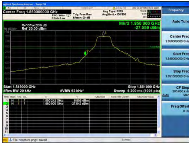
Band2 / 1.4MHz / Low CH / 16QAM / 1 RB
