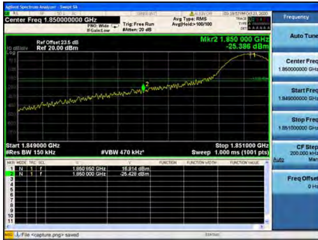
Band2 / 15MHz / Low CH / 16QAM / 1 RB
