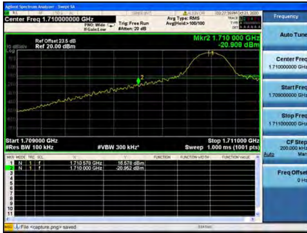
Band4 / 10MHz / Low CH / 16QAM / 1 RB
