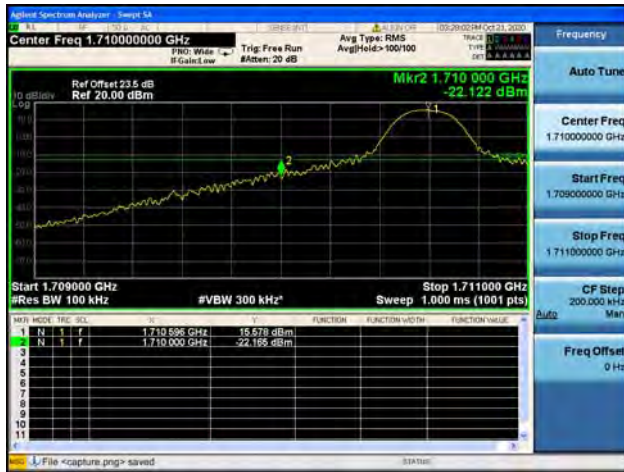
Band4 / 10MHz / Low CH / 16QAM / 1 RB
