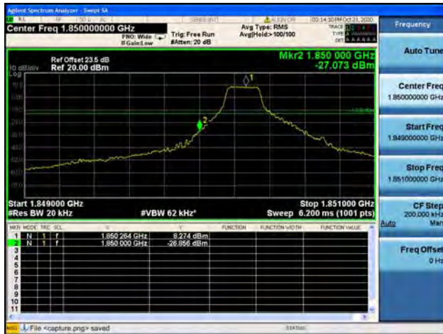
Band2 / 1.4MHz / Low CH / 16QAM / 1 RB
