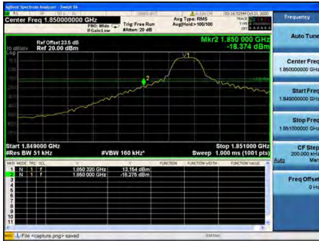
Band2 / 5MHz / Low CH / 16QAM / 1 RB
