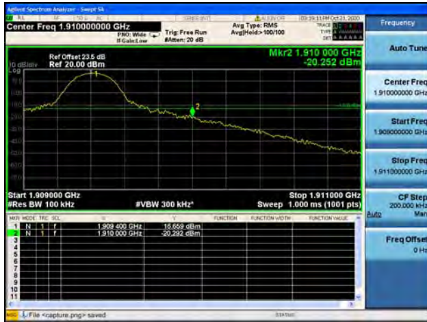
Band2 / 10MHz / High CH / 16QAM / 1 RB
