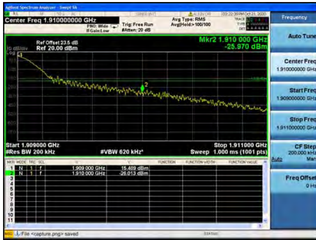
Band2 / 20MHz / High CH / 16QAM / 1 RB
