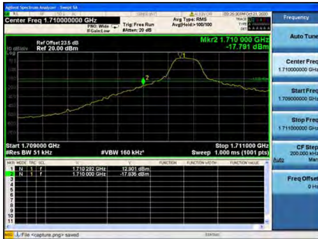
Band4 / 5MHz / Low CH / 16QAM / 1 RB
