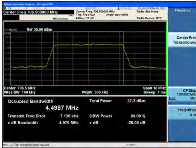
Band17 / 5MHz / Mid CH / QPSK
