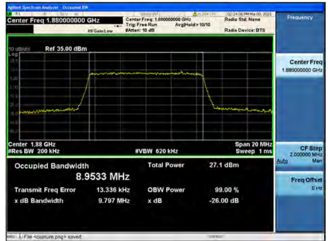
Band2 / 10MHz / High CH / 16QAM
