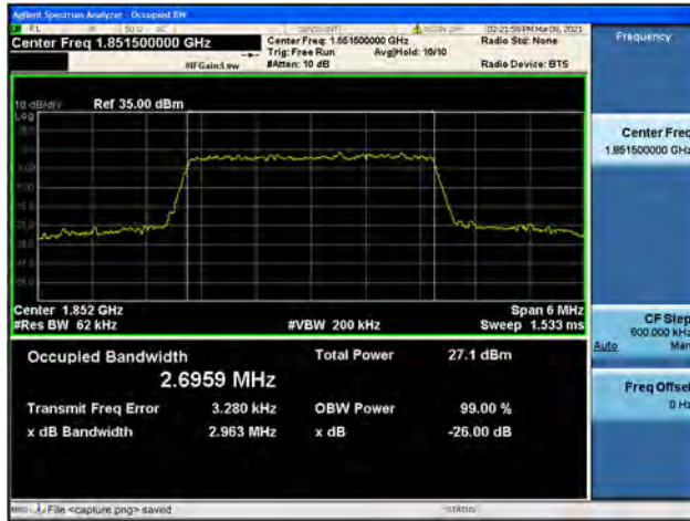
Band2 / 3MHz / Mid CH / QPSK
