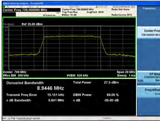
Band17 / 10MHz / Mid CH / QPSK
