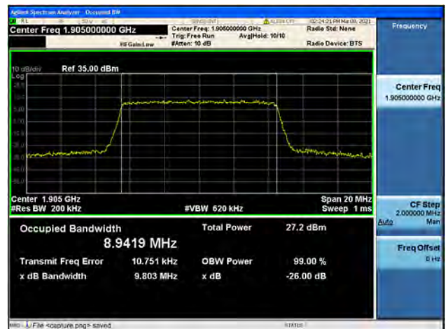
Band2 / 10MHz / High CH / 16QAM
