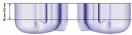
Bi-section sagittale du fantôme avec périmètre étendu (protrée sur le côté comme lors des essais de DAS de l'appareil)
