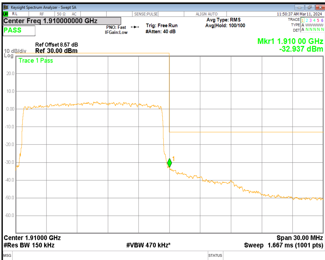
Band2 QPSK BW=20MHz Channel=18700 RB Size=100 Position=#0
