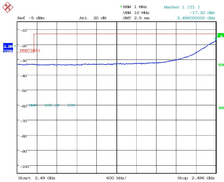
**LOW BAND EDGE BLOCK-15MHz+20MHz-1RB**
