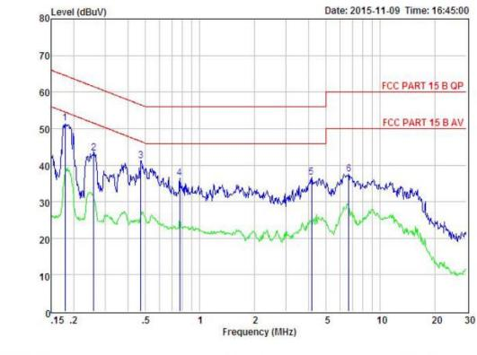
Condition : FCC PART 15 B QP POL: LINE Temp: 24 °C Hum: 56 % EUT :
