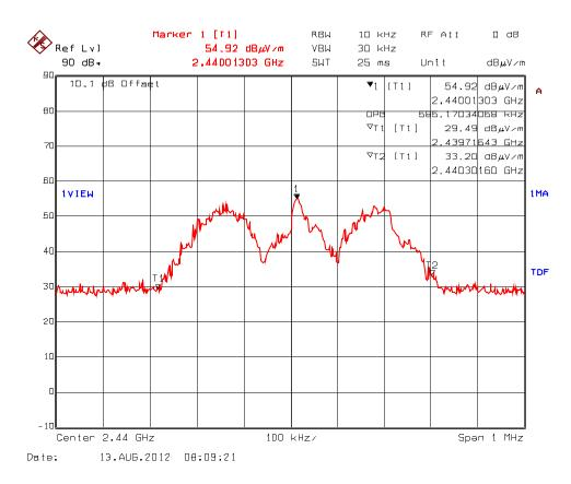
Plot 5.8.4.3. 20 dB Bandwidth Test Frequency: 2480 MHz
