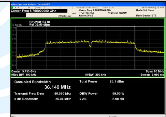
IEEE 802.11ax_Channel 151_40MHz_Antenna 2_RU&Index SU
