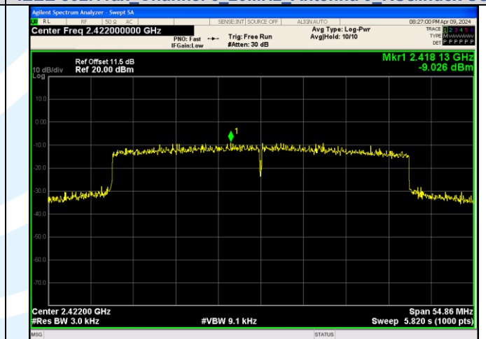
IEEE 802.11ax_Channel 3_40MHz_Antenna 0_RU&Index SU
