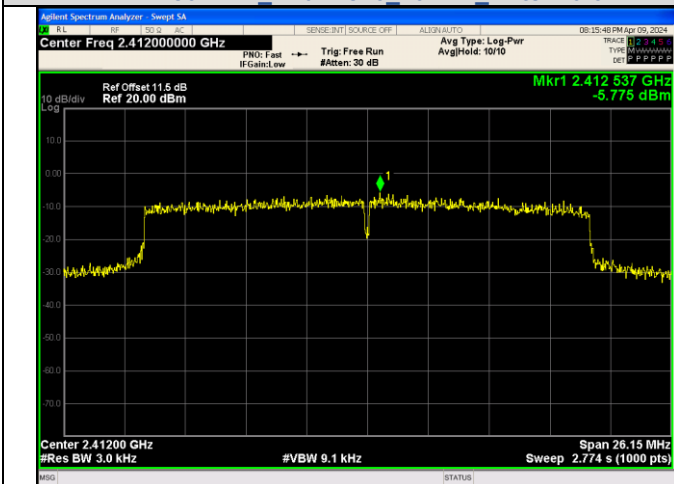
IEEE 802.11ax_Channel 1_20MHz_Antenna 0_RU&Index SU
