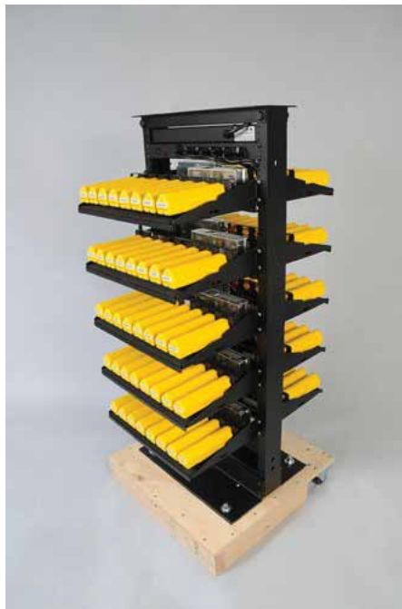
Exemple I-2 Chargeur de batterie
