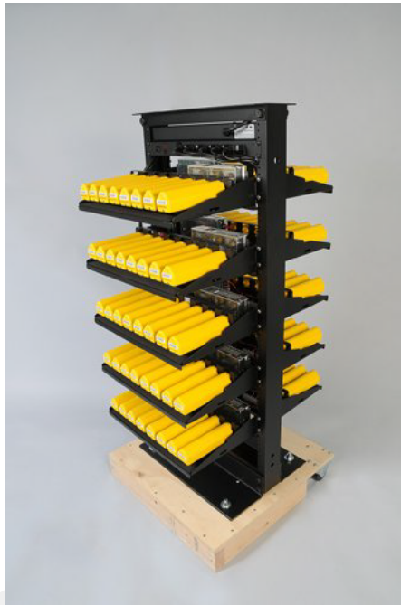
Exemple I-2 Chargeur de batterie
