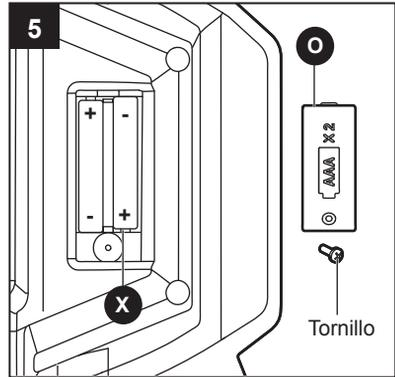
**NOTA:** al cambiar las baterías del reloj, se borrarán todos los ajustes. Para evitar esto, coloque el paquete baterías o enchufe el adaptador de corriente y encienda la unidad antes de reemplazar las baterías del reloj.
