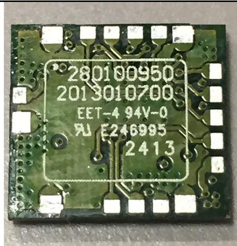
ZWave Module Bottom View
