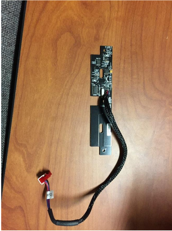
RFID Board – Actual EUT
