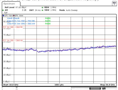
Note 1 : Measured distance : 1 m Note 2 : Limit : Peak : 83.5 dB $\mu$ V/m Average : 63.5 dB $\mu$ V/m
