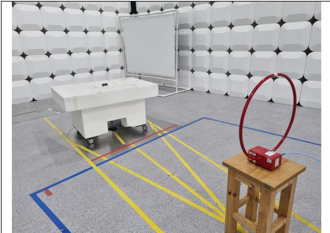
Test distance : 3 m, height of table : 0.8 m
