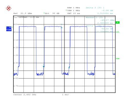
Test mode: π/4DQPSK Test Packet: 2-DH5
