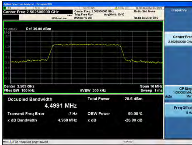
Band7 / 5MHz / Mid CH / QPSK
