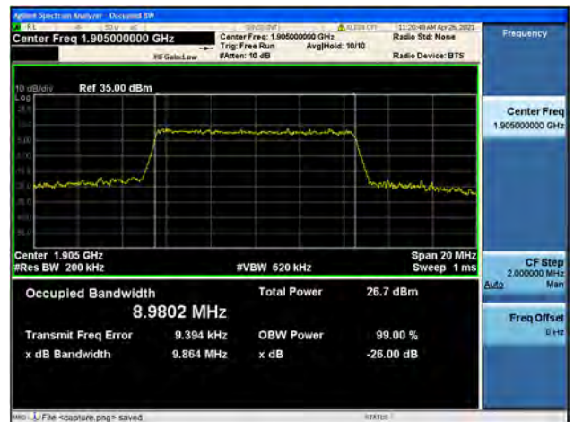
Band2 / 10MHz / High CH / 16QAM
