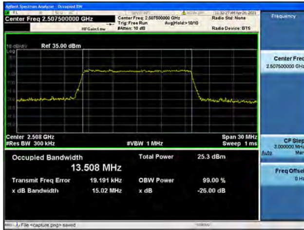
Band7 / 15MHz / Mid CH / QPSK
