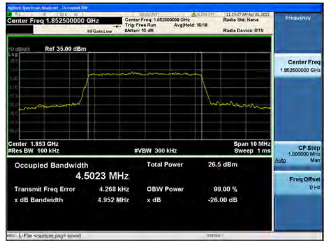
Band2 / 5MHz / Mid CH / 16QAM
