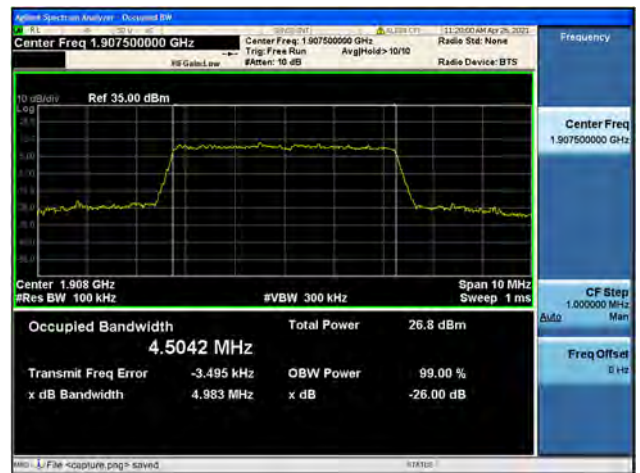
Band2 / 5MHz / High CH / 16QAM
