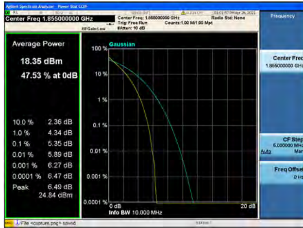
Band2 / 10MHz / Mid CH / QPSK
