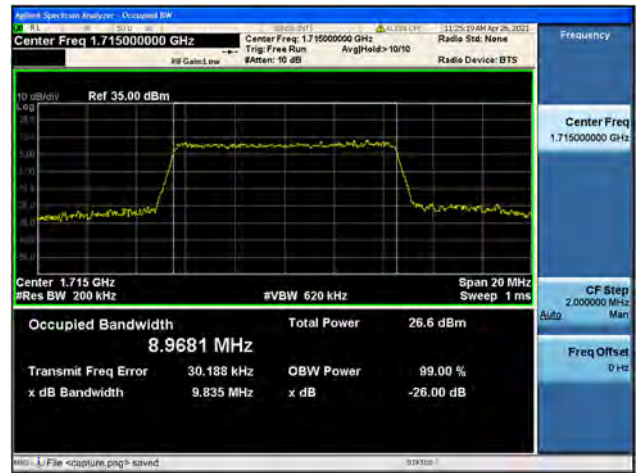
Band4 / 10MHz / Mid CH / 16QAM
