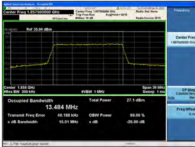
Band2 / 15MHz / Mid CH / QPSK
