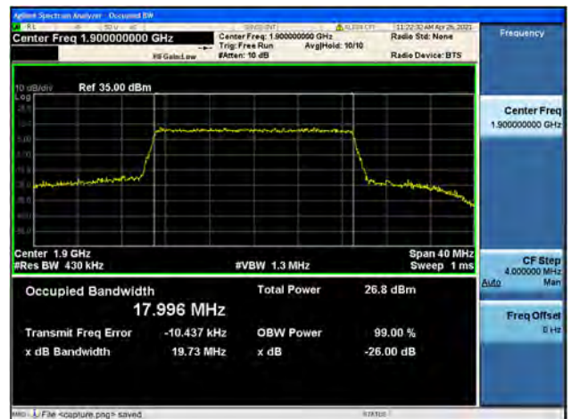
Band2 / 20MHz / High CH / 16QAM
