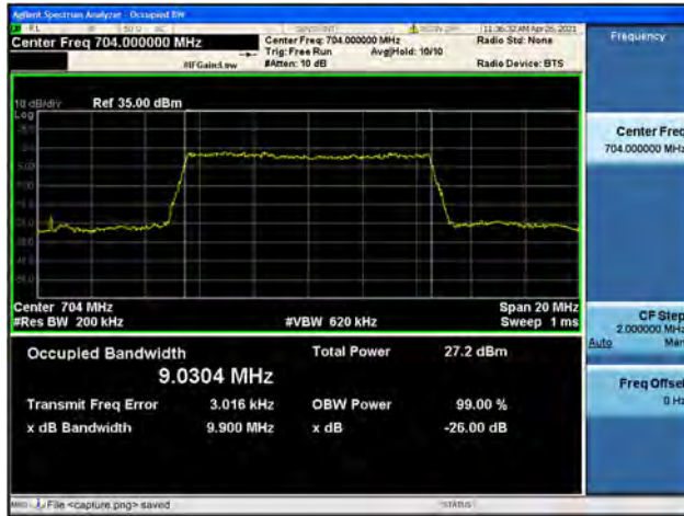
Band12 / 10MHz / Mid CH / QPSK
