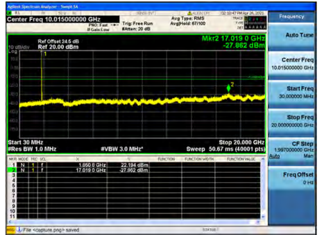
Band2 / 15MHz / Mid CH / 16QAM
