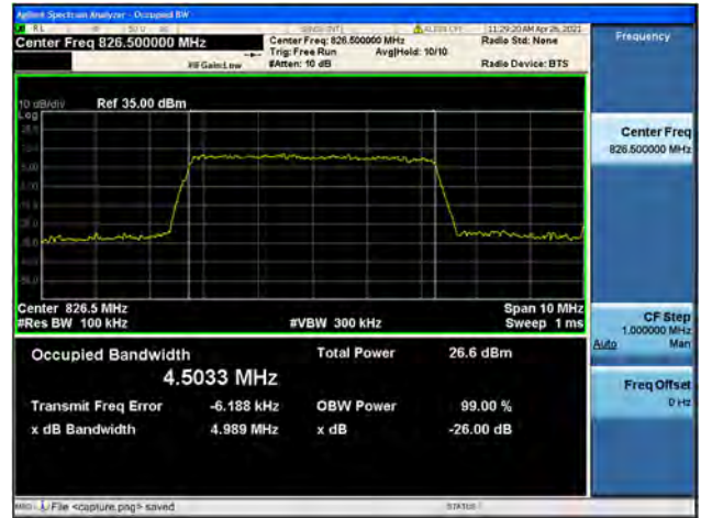
Band5 / 5MHz / Mid CH / 16QAM
