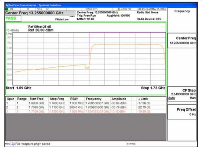
B66 / 20MHz / Low CH / QPSK / FULL RB
