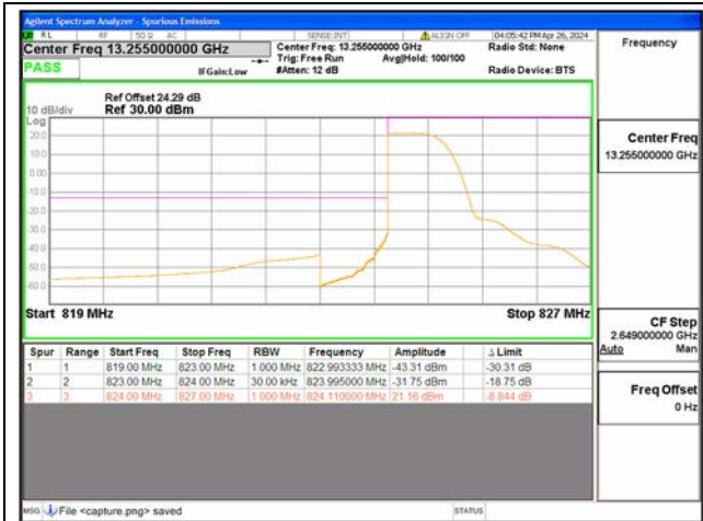
B5 / 1.4MHz / Low CH / QPSK / 1 RB
