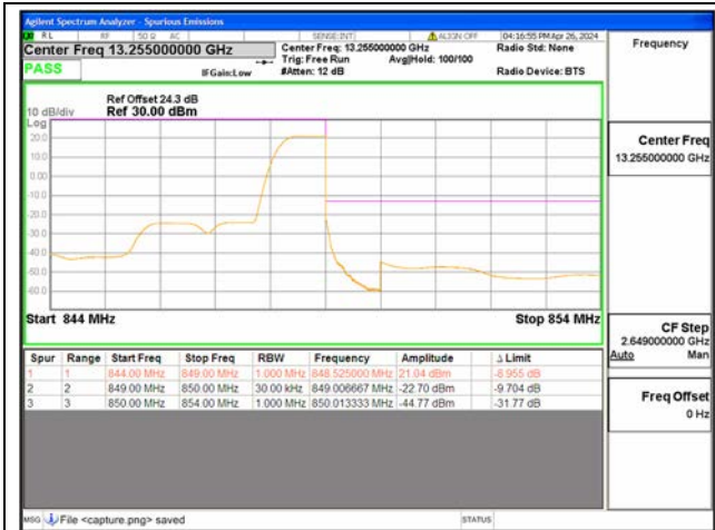
B5 / 3MHz / High CH / QPSK / 1 RB
