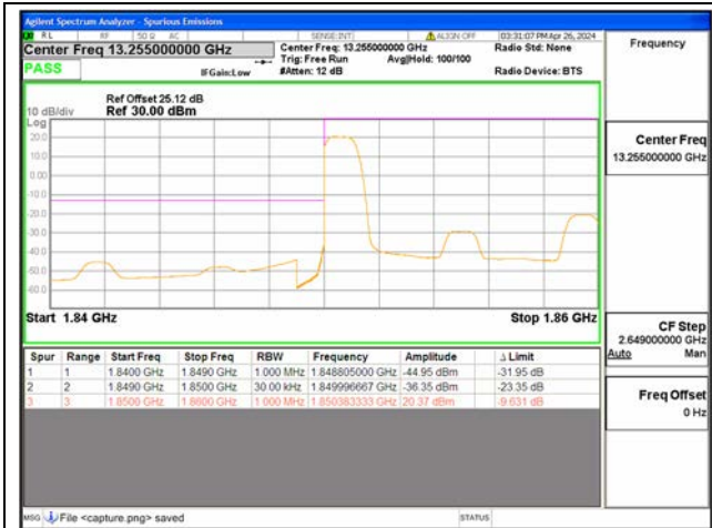
B2 / 10MHz / Low CH / QPSK / 1 RB
