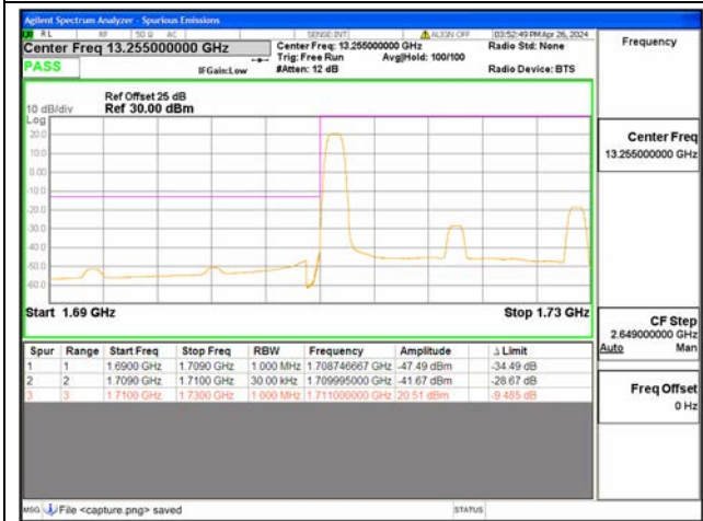
B4 / 20MHz / Low CH / QPSK / 1 RB
