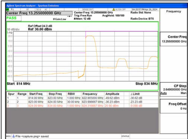
B5 / 10MHz / Low CH / QPSK / 1 RB
