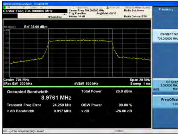
Band12 / 10MHz / Mid CH / QPSK
