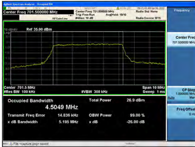
Band12 / 5MHz / Mid CH / QPSK
