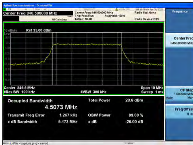
Band5 / 5MHz / High CH / QPSK
