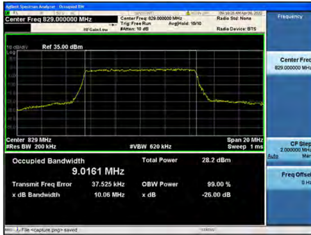
Band5 / 10MHz / Mid CH / QPSK
