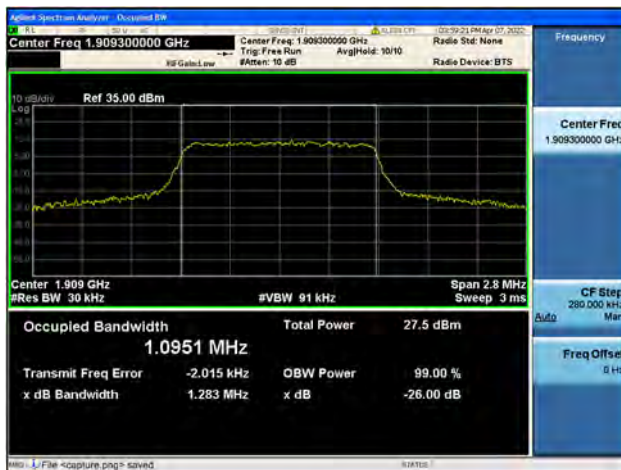
Band2 / 1.4MHz / High CH / QPSK
