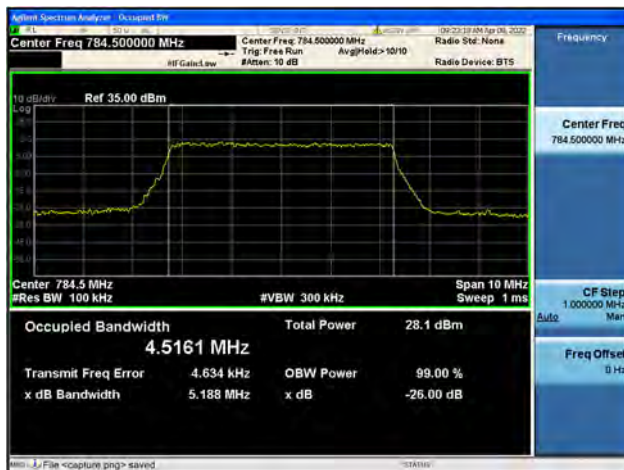
Band13 / 5MHz / High CH / QPSK
