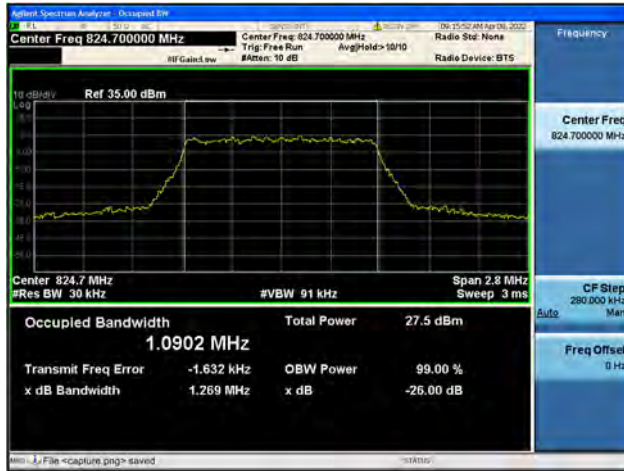
Band5 / 1.4MHz / Mid CH / QPSK
