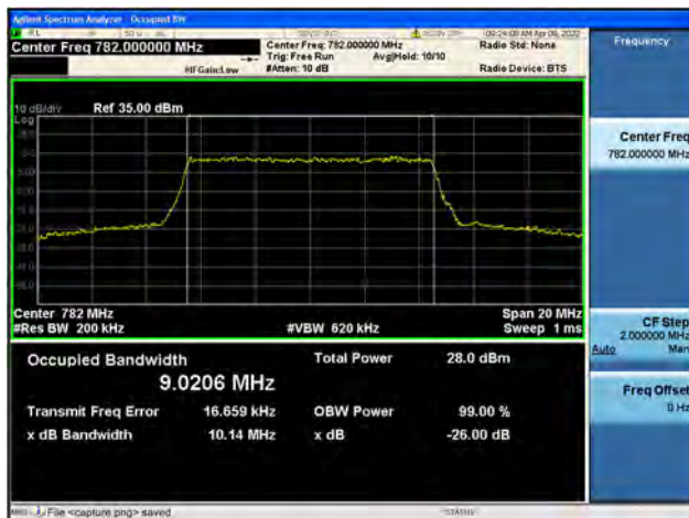
Band13 / 10MHz / High CH / QPSK
