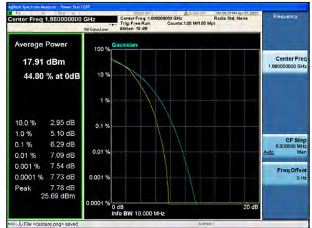
Band2 / 10MHz / High CH / 16QAM
