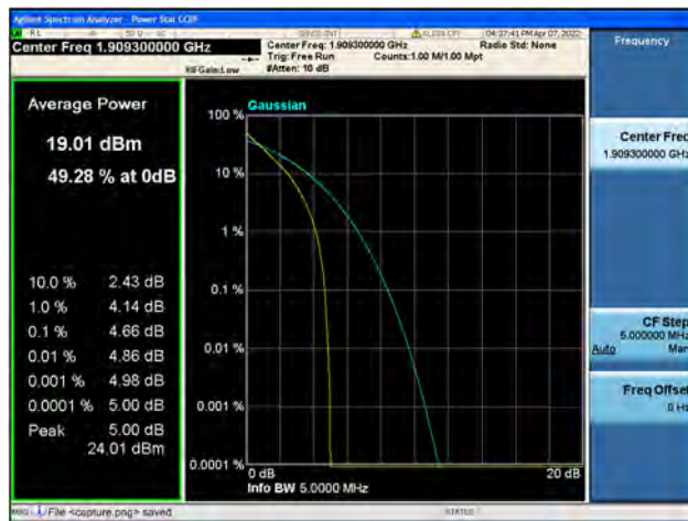
Band2 / 1.4MHz / High CH / QPSK
