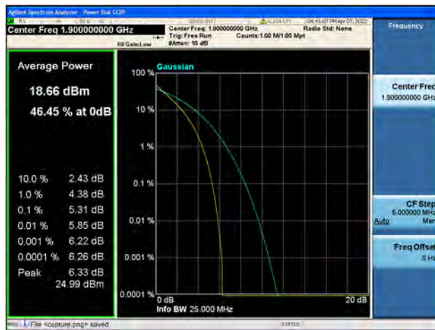
Band2 / 20MHz / High CH / QPSK
