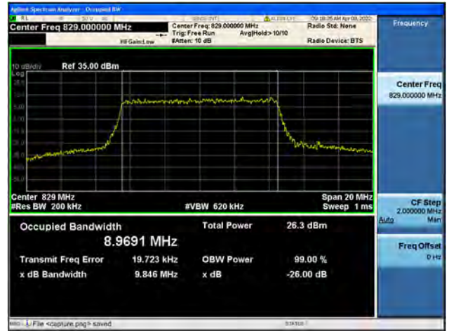
Band5 / 10MHz / Mid CH / 16QAM
