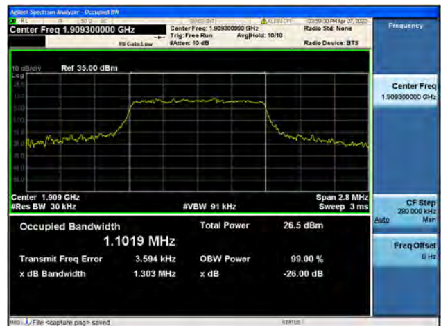
Band2 / 1.4MHz / High CH / 16QAM
