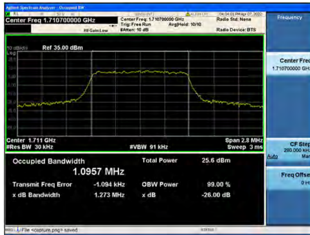
Band4 / 1.4MHz / Mid CH / QPSK
