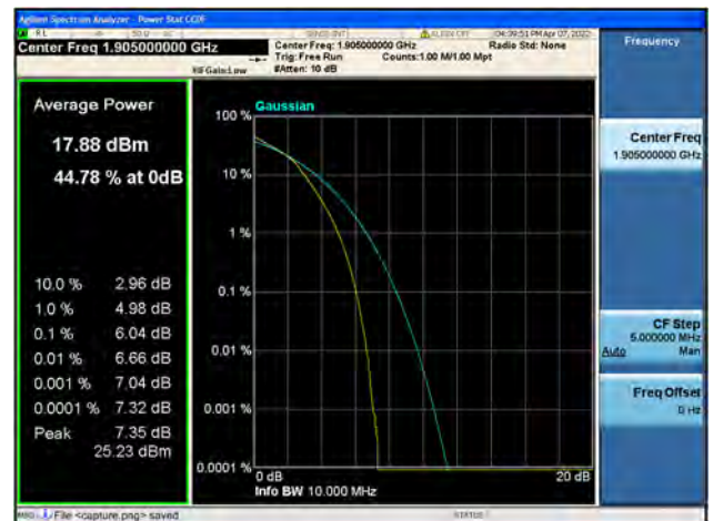
Band2 / 10MHz / High CH / 16QAM
