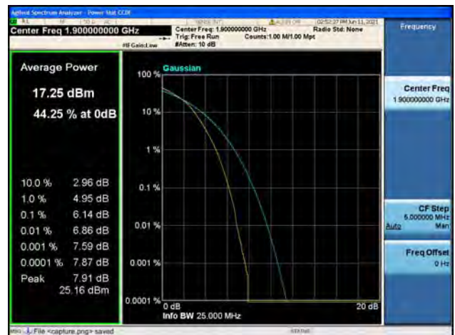
Band2 / 20MHz / High CH / 64QAM
