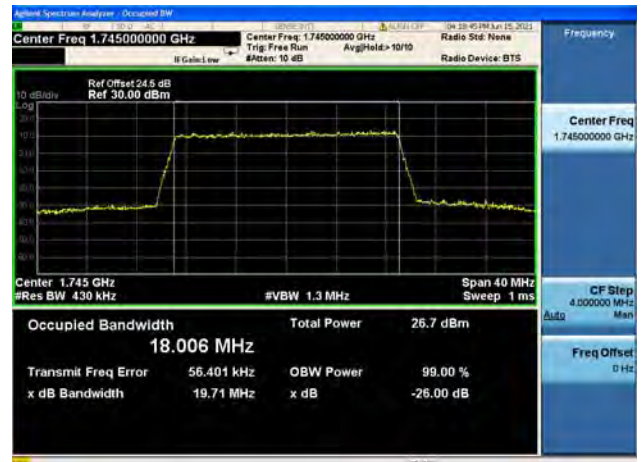
Band66 / 20MHz / High CH / QPSK
