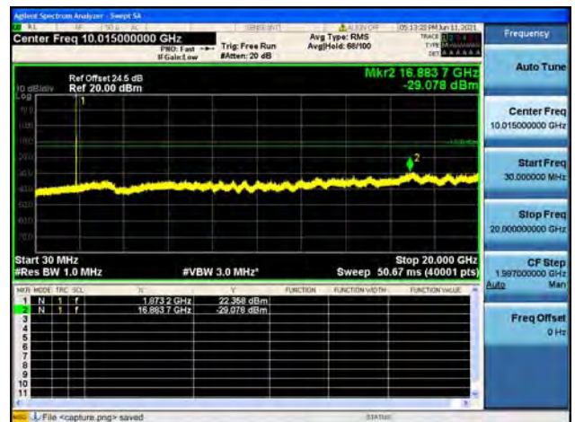
Band2 / 15MHz / Mid CH / 64QAM
