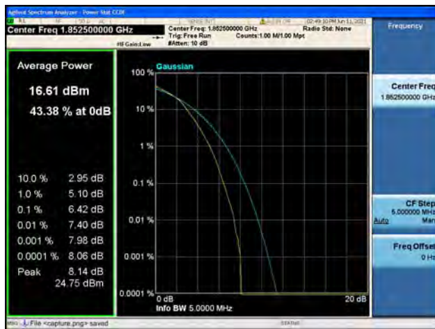
Band2 / 5MHz / Mid CH / 16QAM
