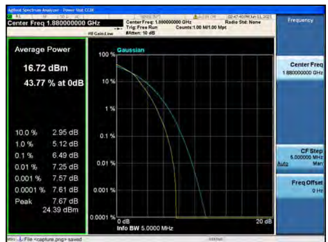
Band2 / 1.4MHz / Mid CH / 64QAM
