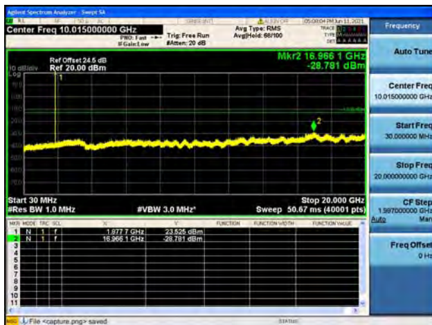
Band2 / 5MHz / Mid CH / 16QAM
