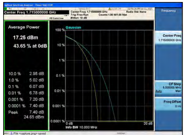
Band4 / 10MHz / Low CH / 64QAM
