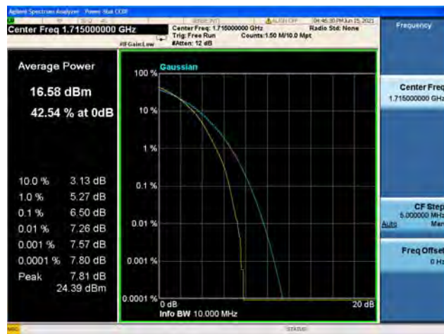
Band66 / 10MHz / Low CH / 16QAM
