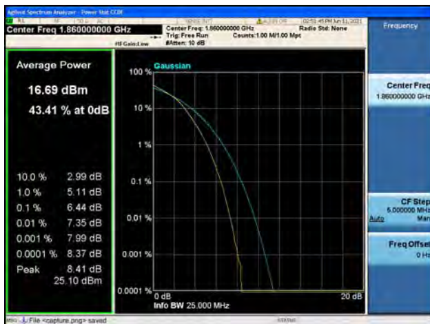
Band2 / 20MHz / Low CH / 16QAM
