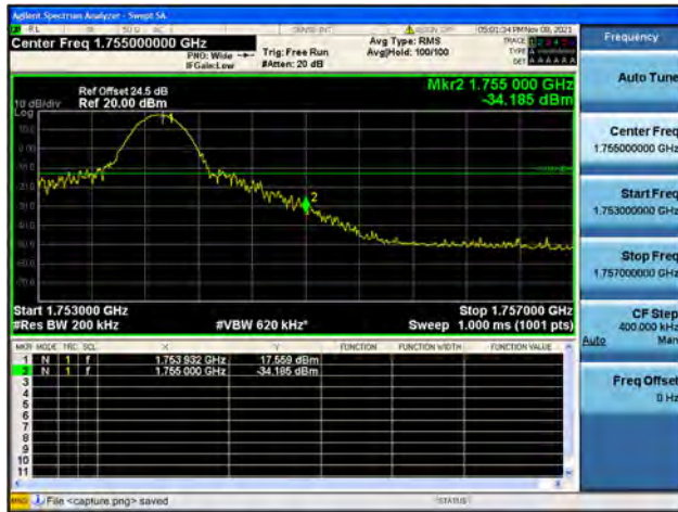
Band4 / 20MHz / High CH / QPSK / 1 RB
