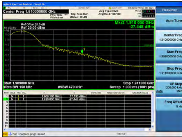
Band2 / 15MHz / High CH / QPSK / 1 RB
