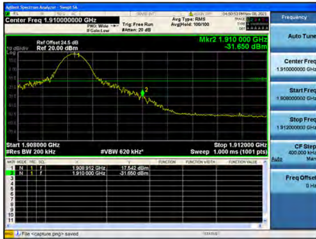
Band2 / 20MHz / High CH / QPSK / 1 RB
