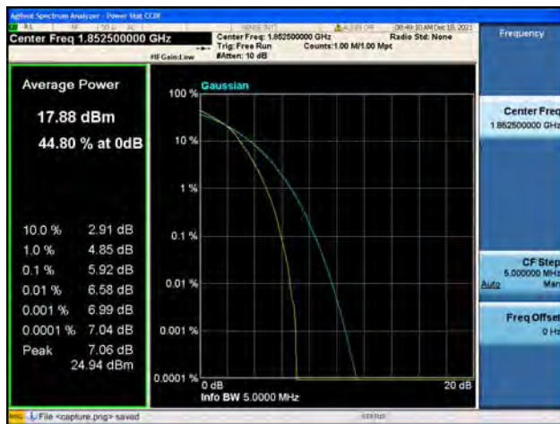
Band2 / 5MHz / Mid CH / 16QAM
