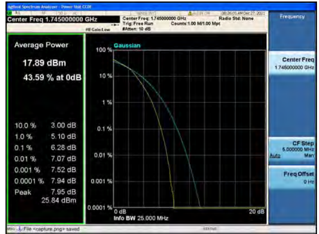
Band66 / 20MHz / High CH / QPSK
