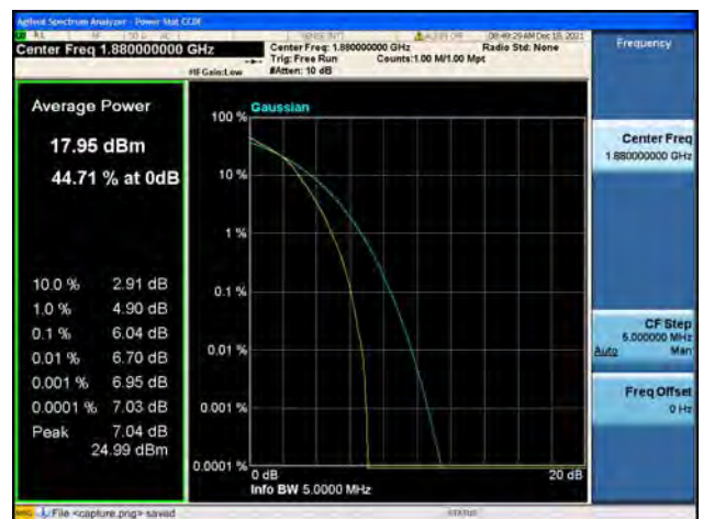
Band2 / 5MHz / Mid CH / 64QAM
