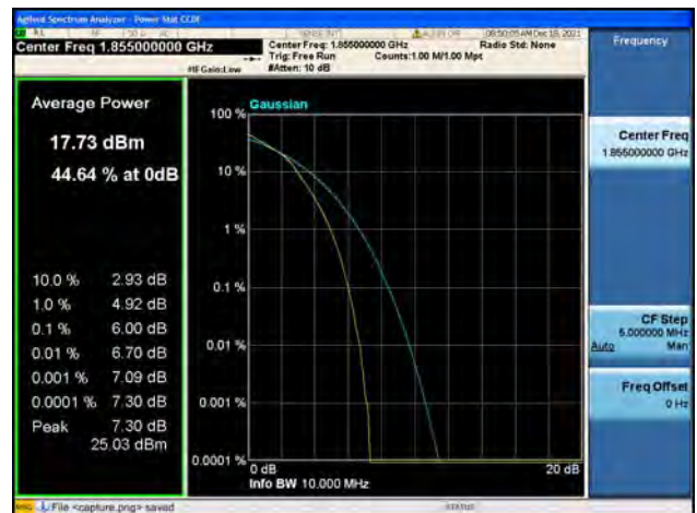
Band2 / 10MHz / Low CH / 64QAM
