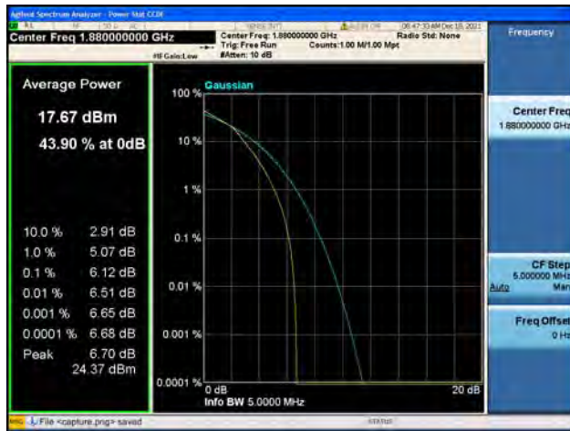
Band2 / 1.4MHz / Mid CH / 16QAM
