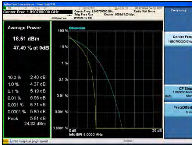
Band2 / 1.4MHz / Low CH / 64QAM
