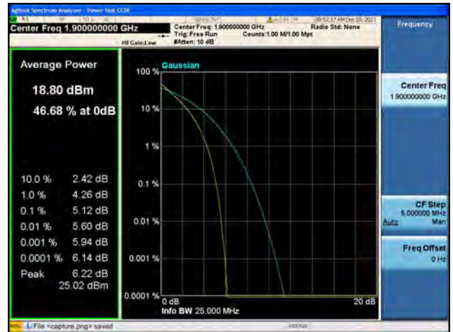
Band2 / 20MHz / High CH / 64QAM
