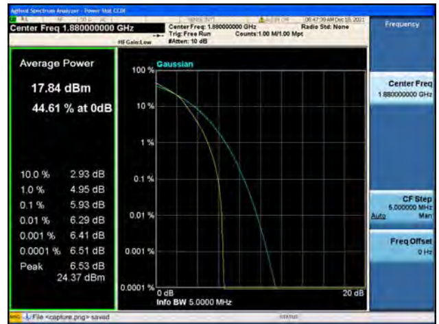
Band2 / 1.4MHz / Mid CH / 64QAM
