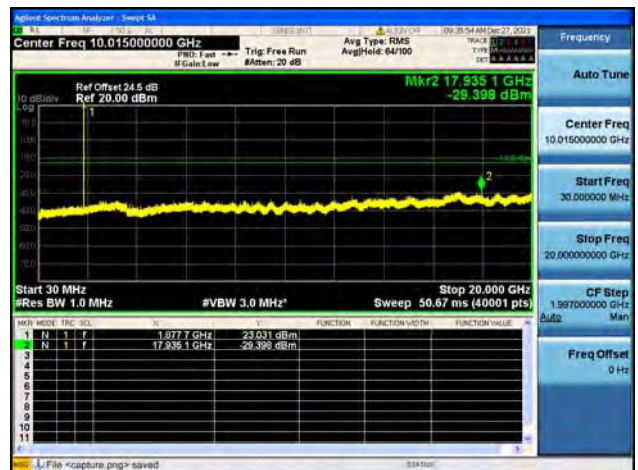
Band2 / 5MHz / Mid CH / 64QAM
