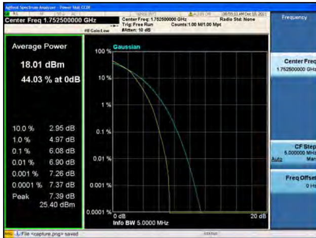
Band4 / 10MHz / Low CH / 16QAM
