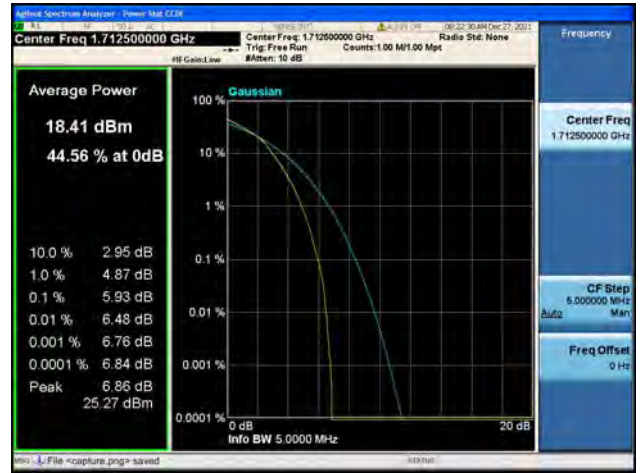
Band66 / 5MHz / Mid CH / QPSK
