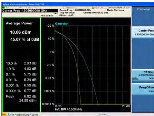
Band2 / 10MHz / High CH / 16QAM
