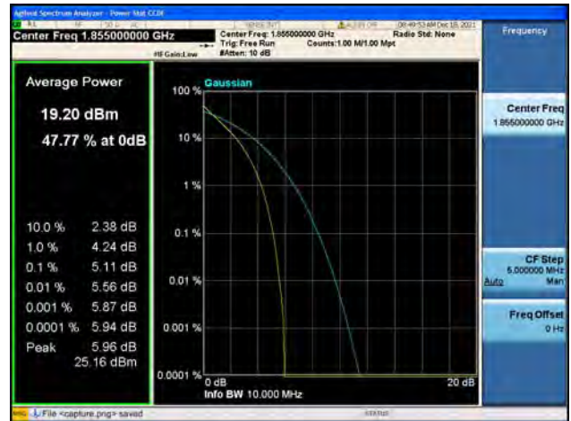
Band2 / 10MHz / Low CH / 64QAM
