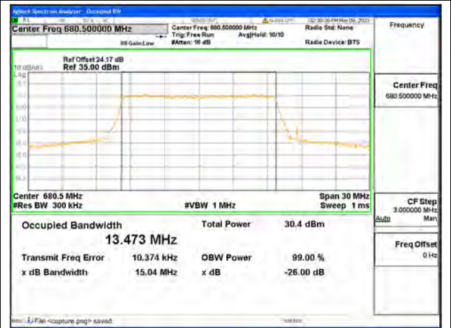
Band71 / 15MHz / QPSK/ Mid CH
