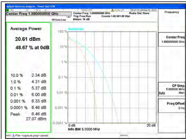
Band2 / 3MHz / Mid CH / QPSK
