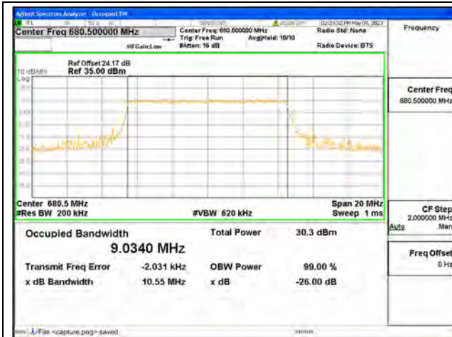
Band71 / 10MHz / QPSK/ Mid CH
