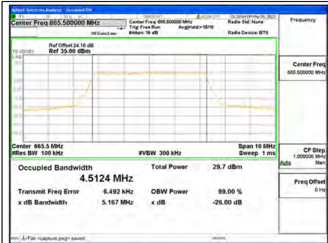
Band71 / 5MHz / QPSK/ Low CH
