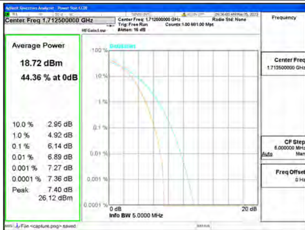
Band4 / 5MHz / Low CH / 64QAM
