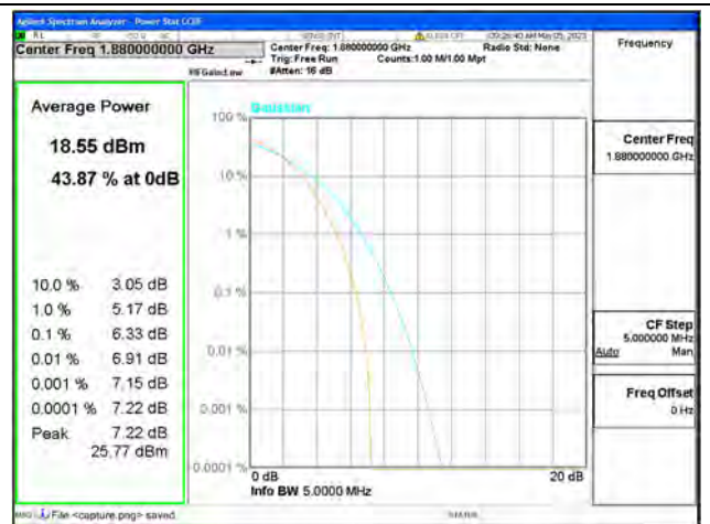
Band2 / 1.4MHz / Mid CH / 64QAM
