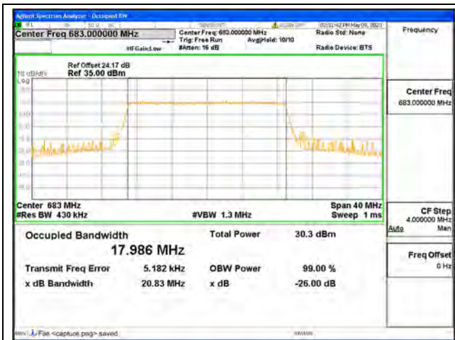
Band71 / 20MHz / QPSK/ Mid CH
