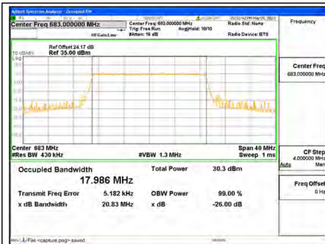
Band71 / 20MHz / QPSK/ Mid CH
