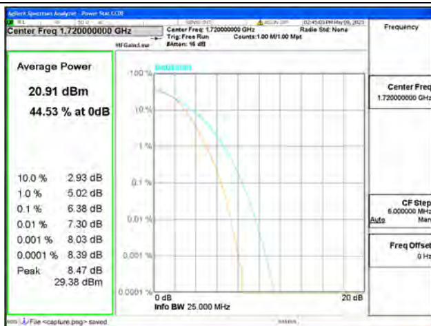
Band66 / 20MHz / Low CH / 16QAM
