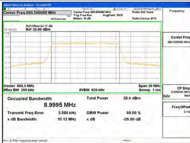
Band71 / 10MHz / 64QAM/ Mid CH
