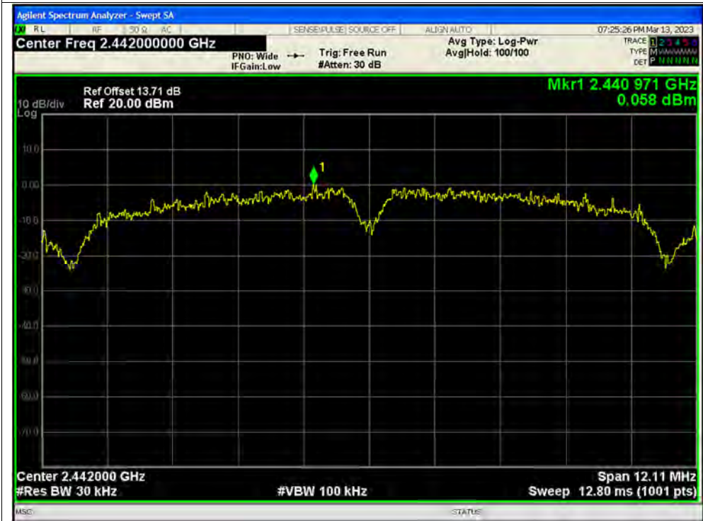
PSD NVNT b 2442MHz Ant1
