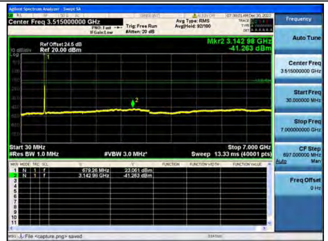
Band71 / 20MHz / High CH / QPSK
