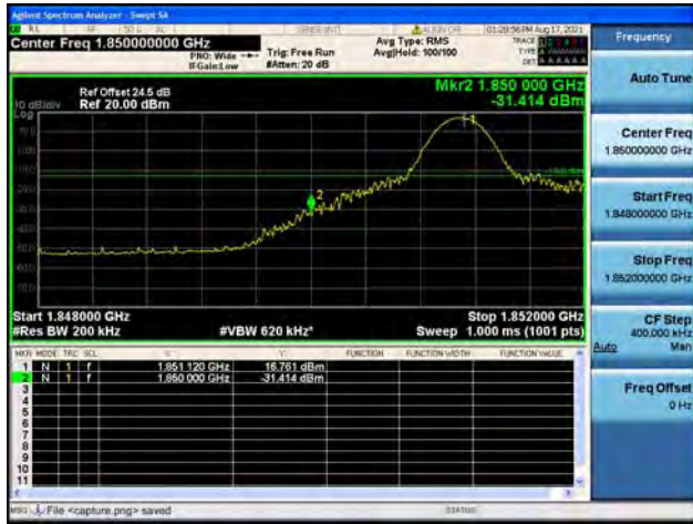
Band2 / 20MHz / High CH / QPSK / 1 RB
