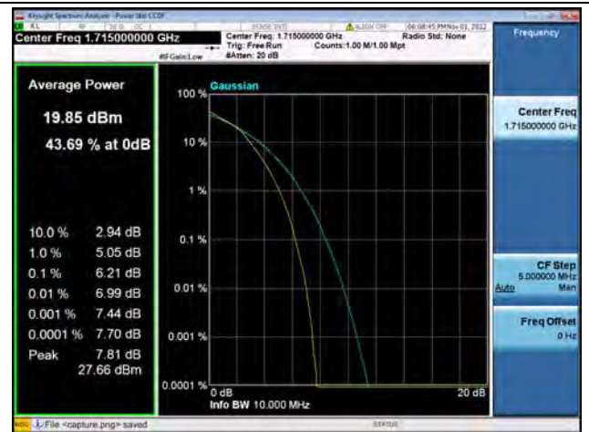
Band4 / 10MHz / Low CH / 16QAM
