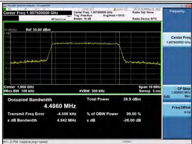
Band2 / 5MHz / QPSK/ High CH
