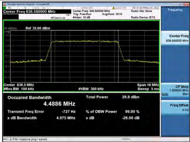
Band5 / 5MHz / QPSK/ Mid CH
