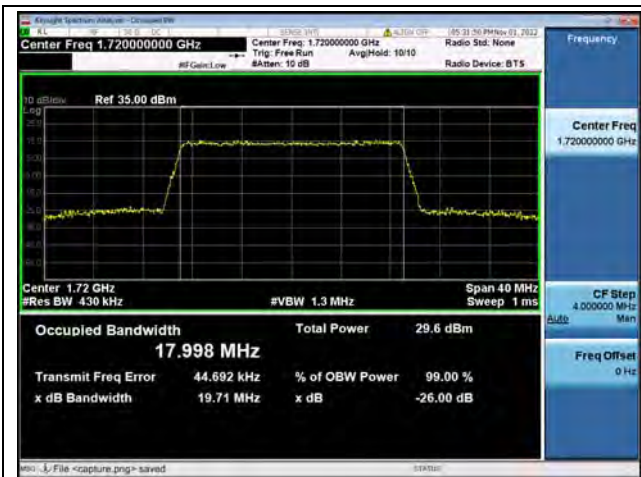
Band4 / 20MHz / QPSK/ Low CH
