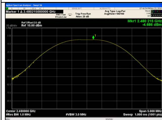
AV Output power - High CH 2480
