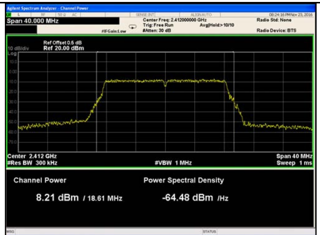
802.11g - AV Output power - Low CH 2412
