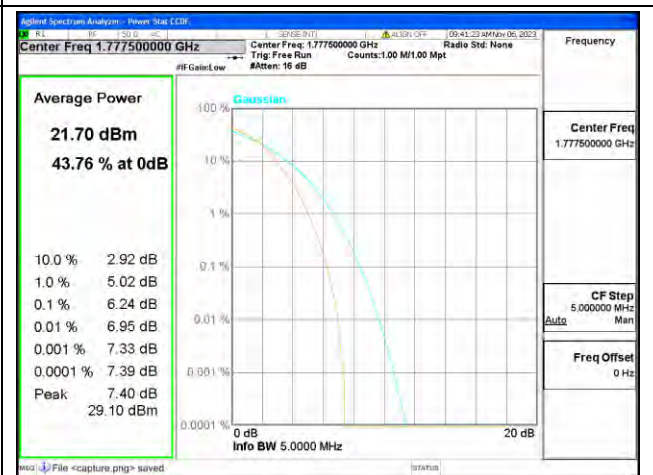
B66 / 5MHz / High CH / 16QAM
