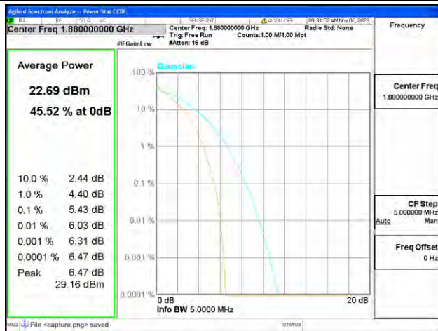
B2 / 5MHz / Mid CH / QPSK
