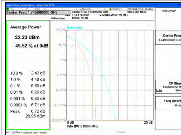
B66 / 5MHz / Mid CH / QPSK
