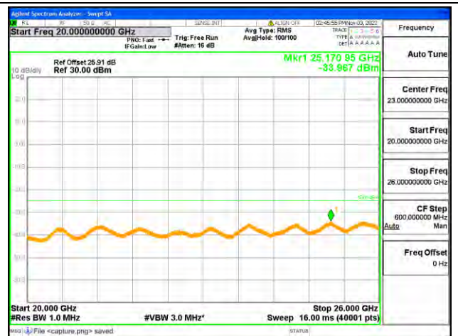
B7-20G-26G / 10MHz / High CH / QPSK
