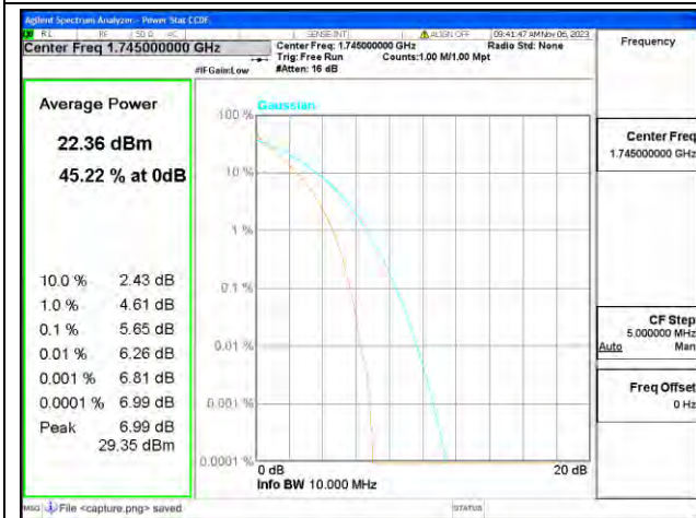
B66 / 10MHz / Mid CH / QPSK
