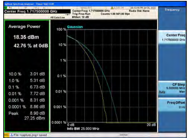
Band4 / 15MHz / Mid CH / QPSK
