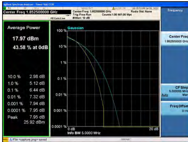
Band2 / 5MHz / Mid CH / 16QAM
