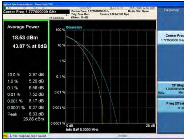
Band66 / 10MHz / Low CH / 16QAM
