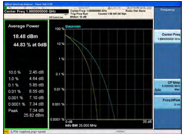
Band2 / 15MHz / Mid CH / 64QAM
