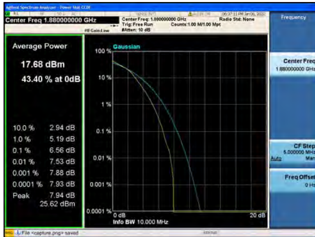
Band2 / 10MHz / High CH / 16QAM
