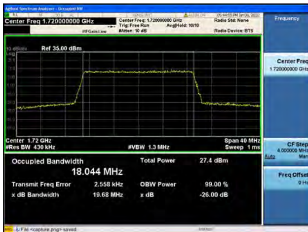
Band66 / 20MHz / Low CH / 16QAM
