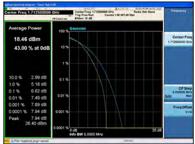
Band66 / 5MHz / Mid CH / QPSK
