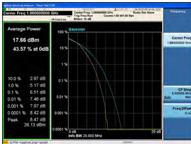
Band2 / 15MHz / Mid CH / 16QAM
