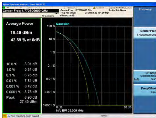
Band66 / 20MHz / Low CH / 16QAM
