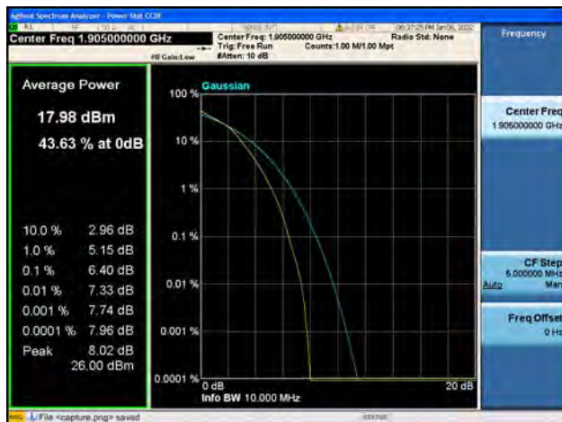
Band2 / 10MHz / High CH / 16QAM
