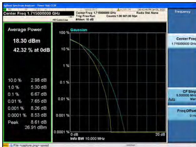
Band4 / 10MHz / Low CH / 16QAM
