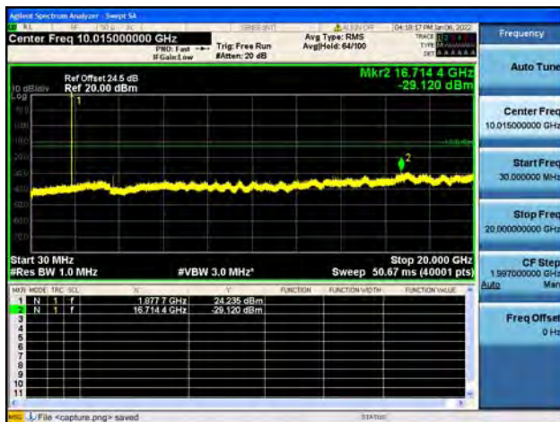
Band2 / 5MHz / Mid CH / 16QAM
