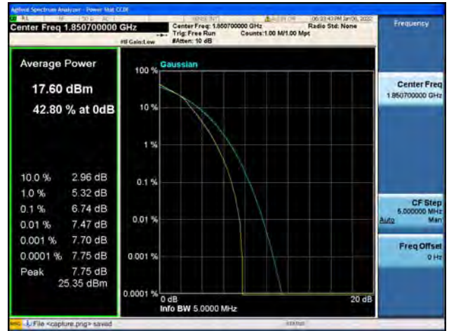
Band2 / 1.4MHz / Mid CH / QPSK
