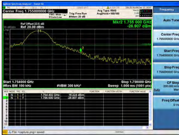
Band4 / 15MHz / Low CH / QPSK / 1 RB
