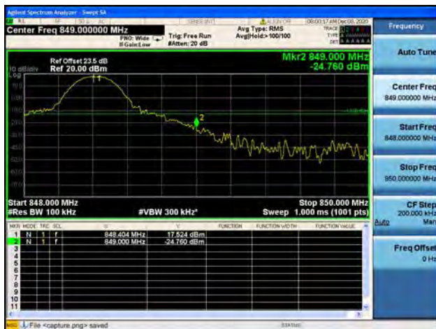
Band5 / 10MHz / High CH / QPSK / 1 RB
