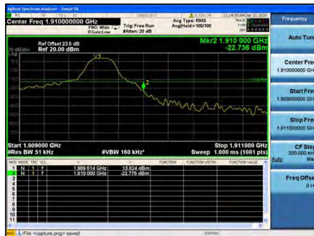
Band2 / 5MHz / High CH / 16QAM / 1 RB
