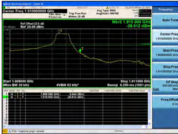
Band2 / 3MHz / Low CH / QPSK / 1 RB
