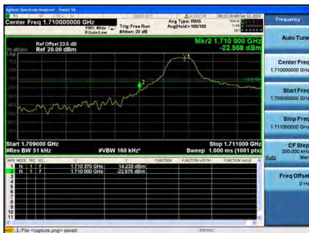
Band4 / 5MHz / Low CH / QPSK / 1 RB
