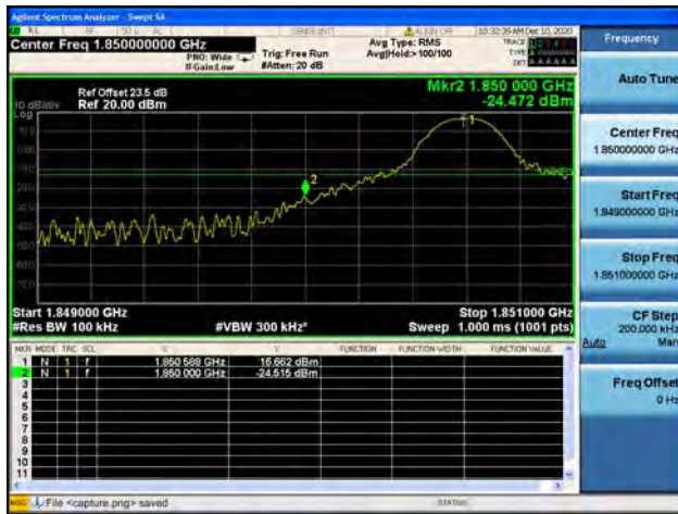
Band2 / 10MHz / Low CH / 16QAM / 1 RB
