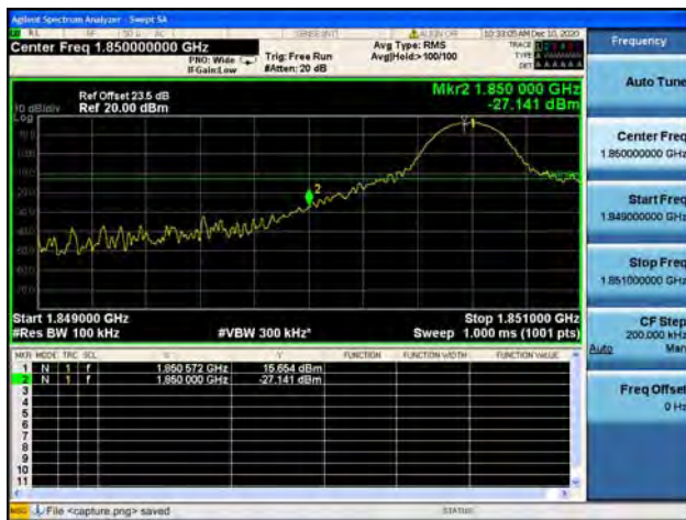
Band2 / 10MHz / High CH / QPSK / 1 RB
