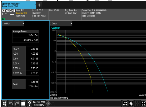
B7 20M 64QAM 100@0 CH 21350
