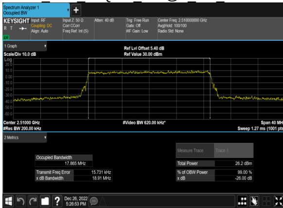
B7 20M 64QAM 100@0 CH 21350
