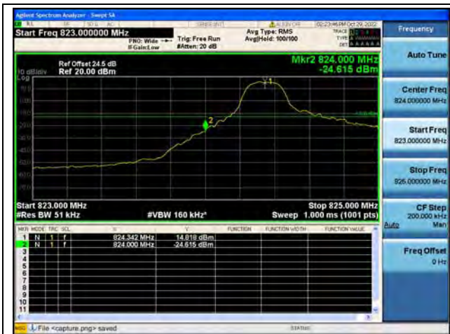
Band5 / 5MHz / Low CH / QPSK / 1 RB
