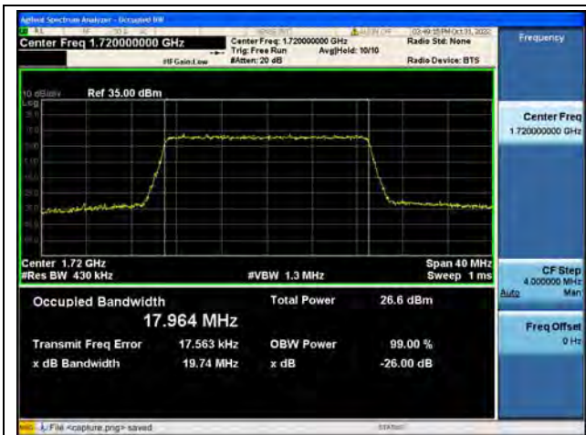
Band66 / 20MHz / QPSK/ Low CH
