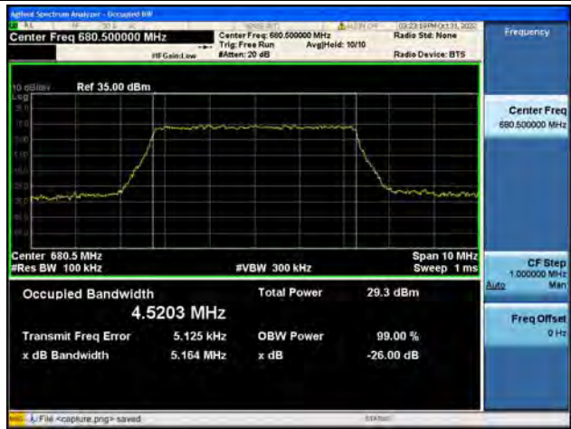
Band71 / 5MHz / QPSK/ Mid CH
