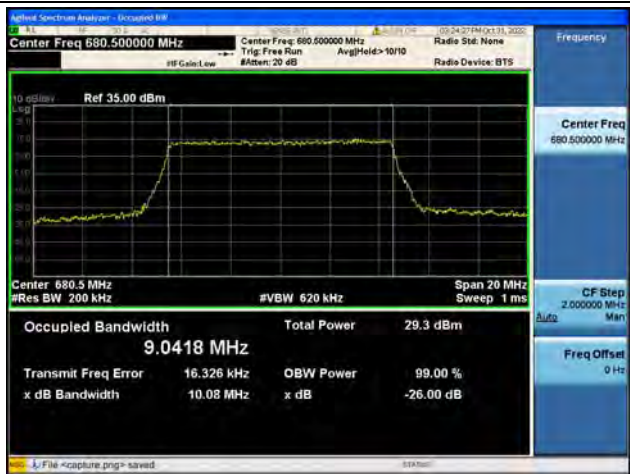
Band71 / 10MHz / QPSK/ Mid CH
