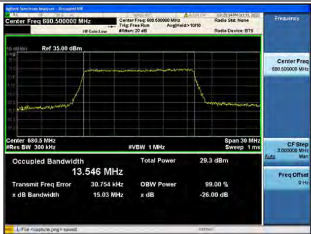
Band71 / 15MHz / QPSK/ Mid CH
