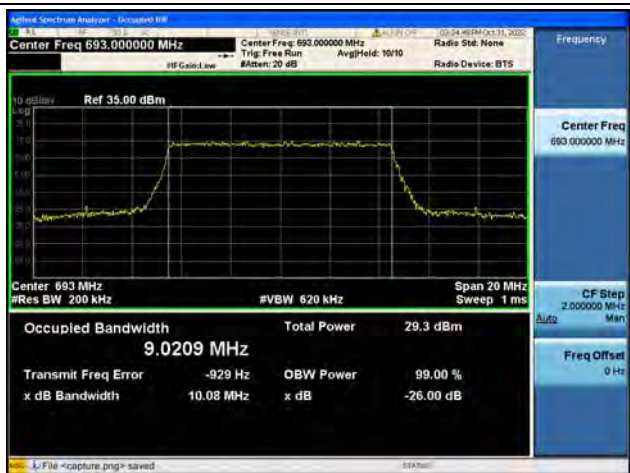
Band71 / 10MHz / QPSK/ High CH
