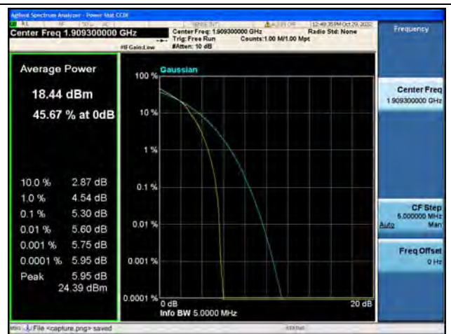
Band2 / 1.4MHz / High CH / 16QAM
