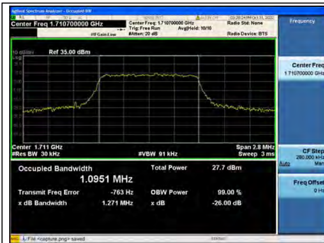
Band4 / 1.4MHz / QPSK/ Low CH
