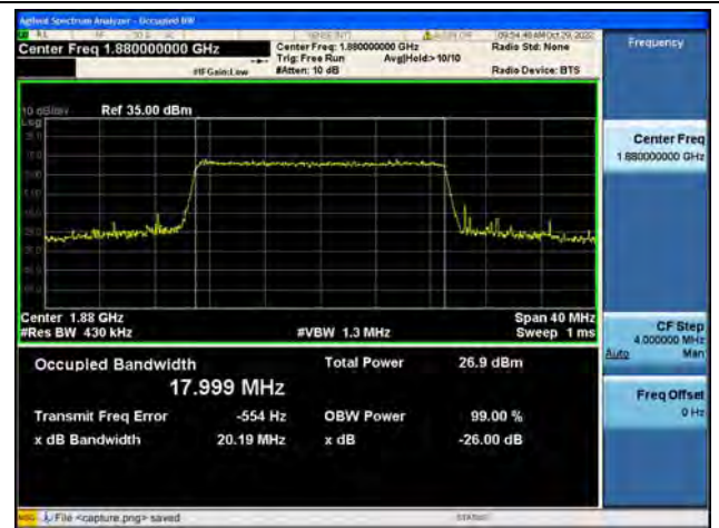
Band2 / 20MHz / 16QAM/ Mid CH
