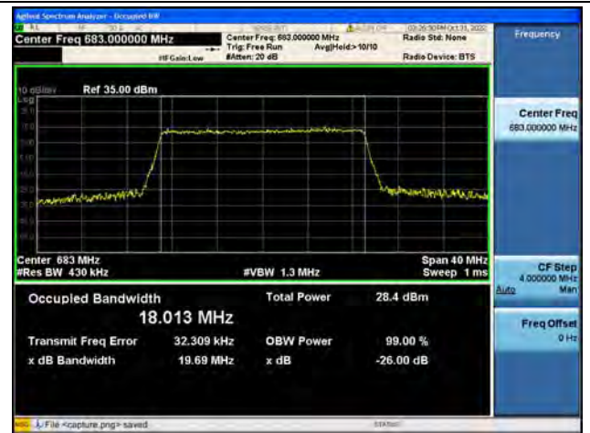
Band71 / 20MHz / 16QAM/ Mid CH
