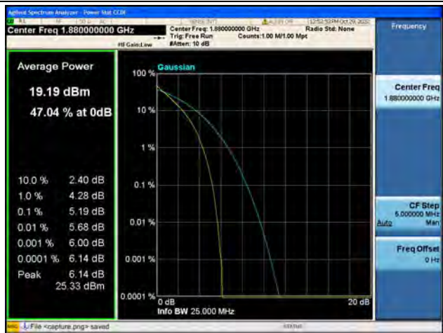
Band2 / 15MHz / Mid CH / QPSK
