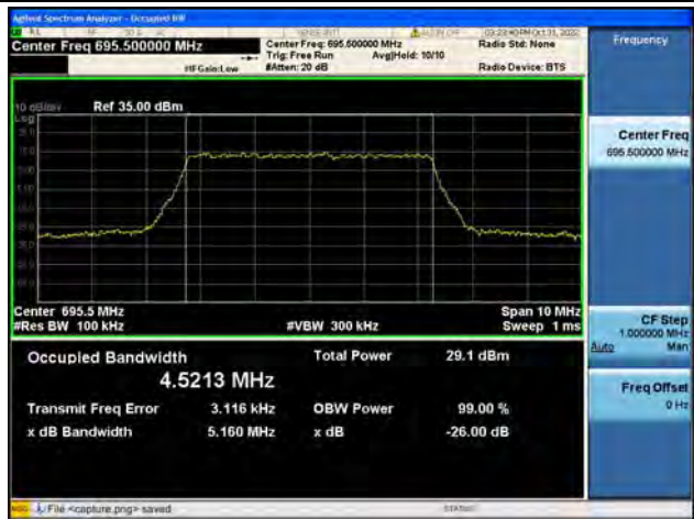
Band71 / 5MHz / QPSK/ High CH
