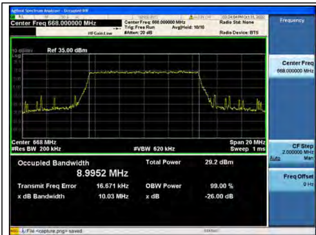
Band71 / 10MHz / QPSK/ Low CH
