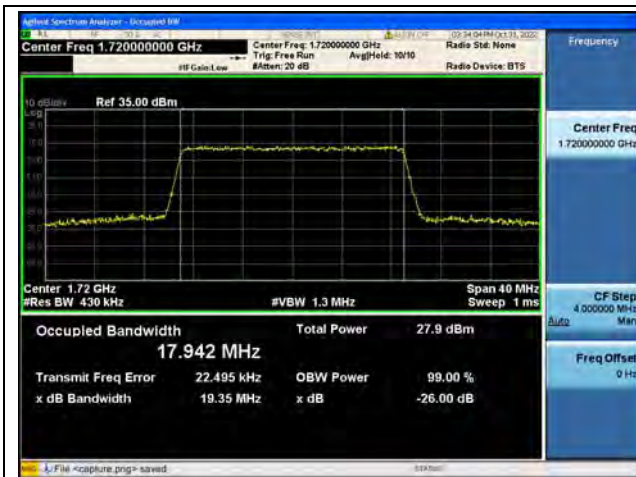
Band4 / 20MHz / QPSK/ Low CH
