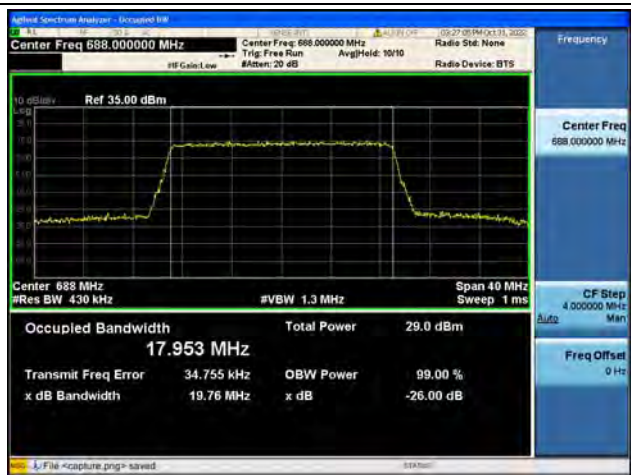
Band71 / 20MHz / QPSK/ High CH
