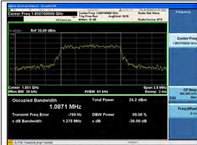
Band2 / 1.4MHz / QPSK/ Low CH
