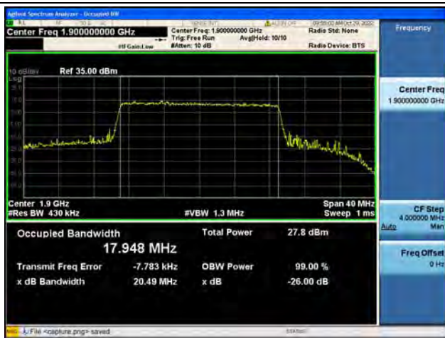
Band2 / 20MHz / QPSK/ High CH
