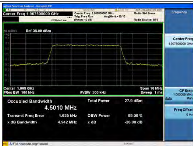
Band2 / 5MHz / QPSK/ High CH
