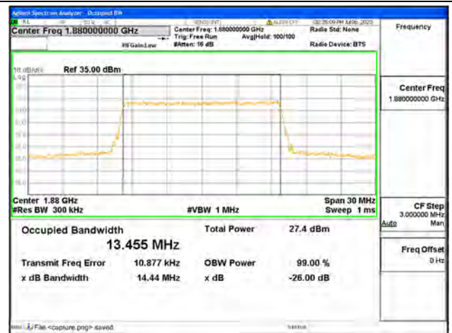
Band2 / 15MHz / QPSK/ Mid CH
