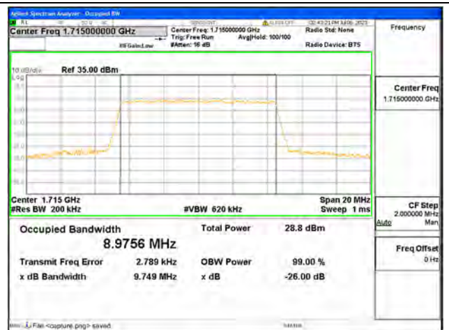
Band4 / 10MHz / 64QAM / Low CH
