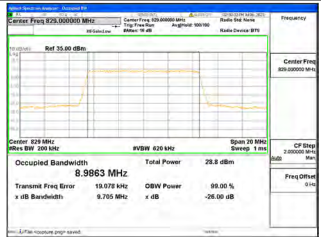
Band5 / 10MHz / QPSK/ Low CH
