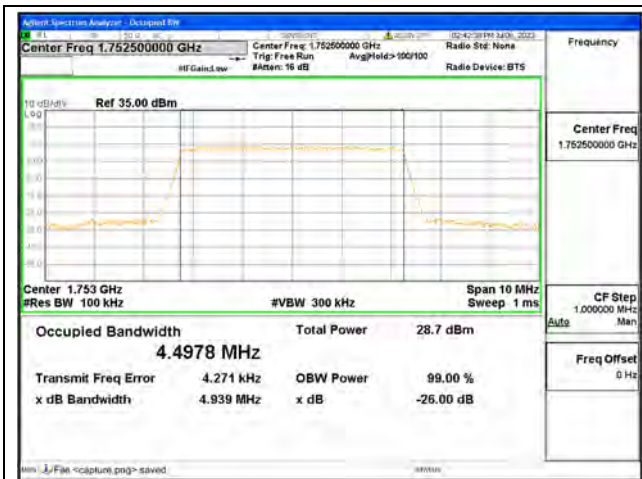
Band4 / 5MHz / QPSK / High CH
