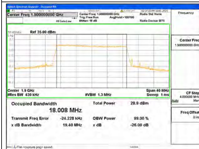
Band2 / 20MHz / 16QAM / High CH
