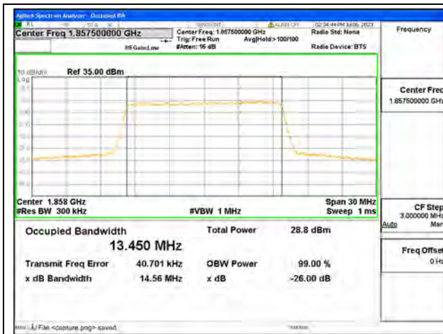
Band2 / 15MHz / QPSK/ Low CH
