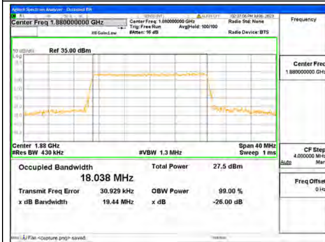
Band2 / 20MHz / 64QAM / Mid CH
