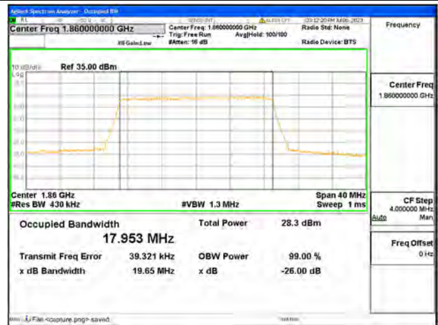
Band25 / 20MHz / QPSK/ Low CH
