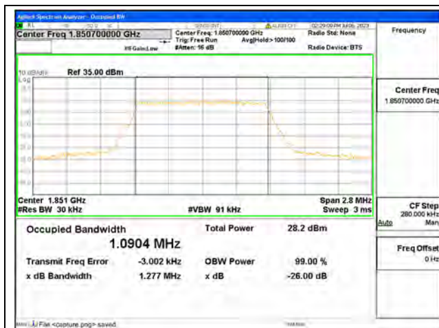
Band2 / 1.4MHz / QPSK/ Low CH
