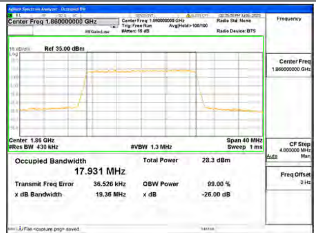
Band2 / 20MHz / QPSK/ Low CH
