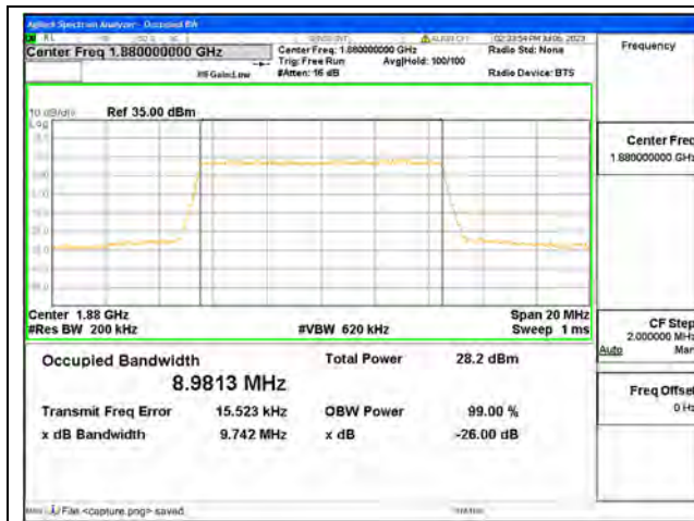
Band2 / 10MHz / QPSK/ Mid CH
