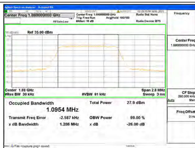
Band2 / 1.4MHz / QPSK/ Mid CH
