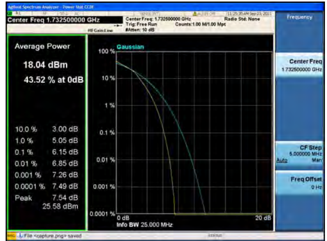
Band4 / 20MHz / High CH / QPSK
