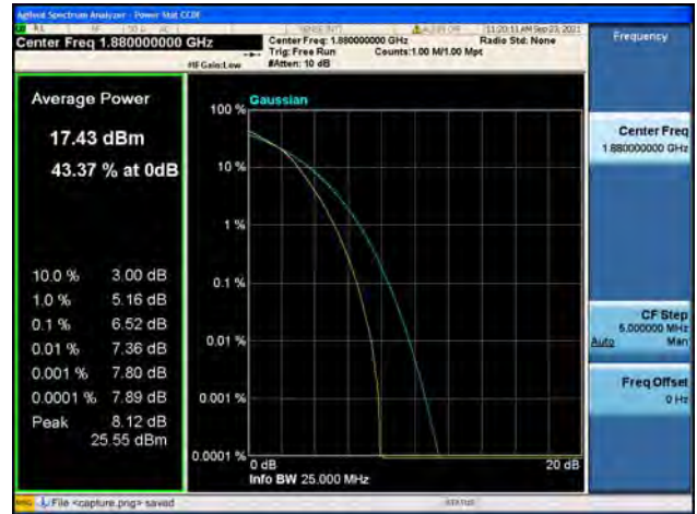
Band2 / 20MHz / High CH / QPSK
