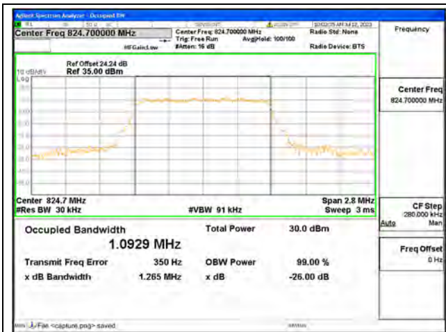
Band5 / 1.4MHz / QPSK/ Low CH
