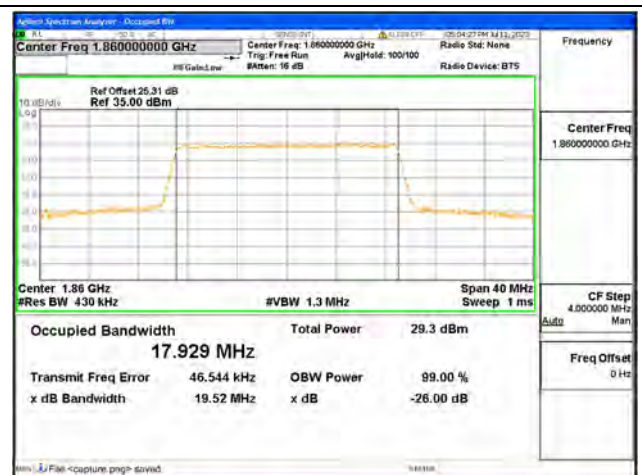
Band2 / 20MHz / 64QAM/ Low CH
