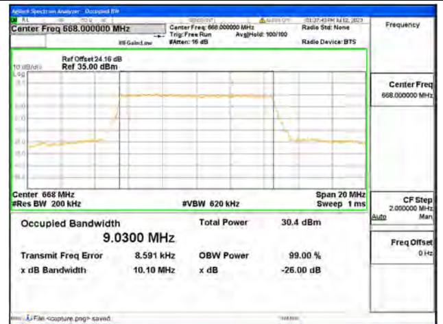
Band71 / 10MHz / QPSK/ Low CH
