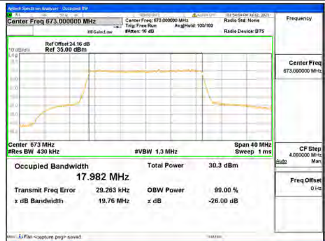
Band71 / 20MHz / QPSK/ Low CH
