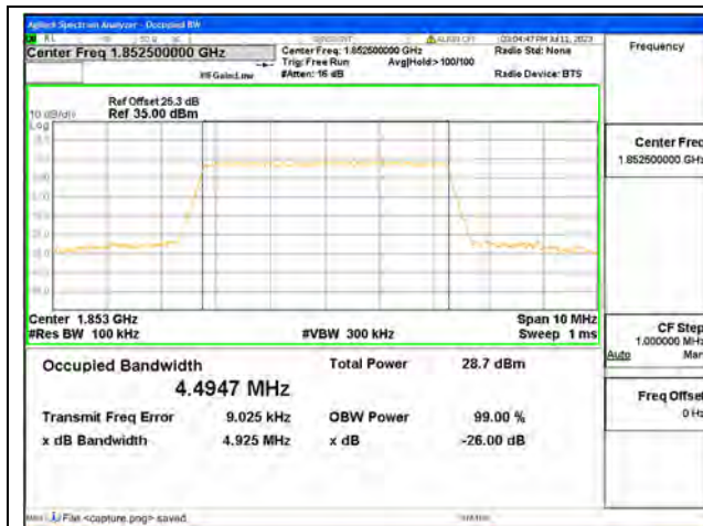
Band2 / 5MHz / QPSK/ Low CH
