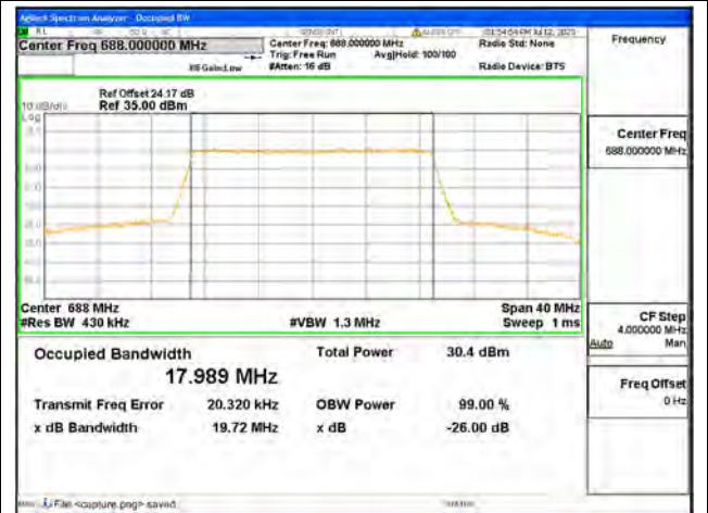
Band71 / 20MHz / QPSK/ High CH
