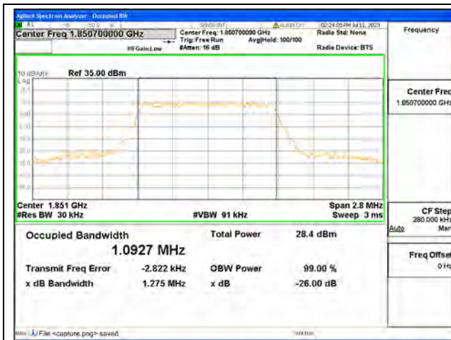
Band2 / 1.4MHz / QPSK/ Low CH
