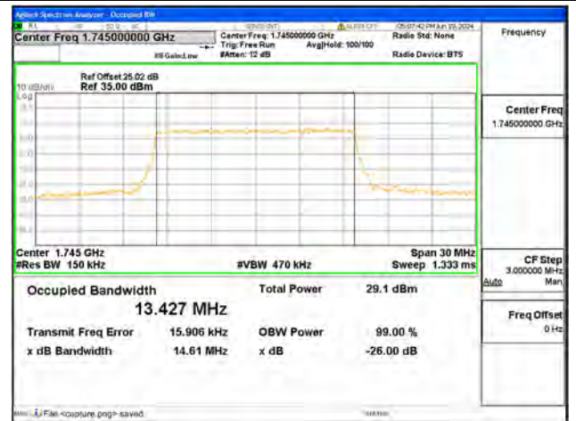
B66 / 15MHz / QPSK/ Mid CH
