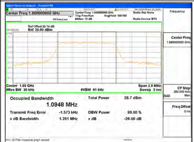
B2 / 1.4MHz / QPSK/ Mid CH
