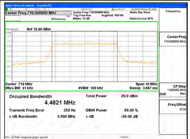
B17 / 5MHz / QPSK/ Mid CH
