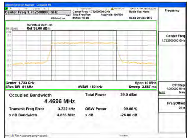
B4 / 5MHz / QPSK/ Mid CH
