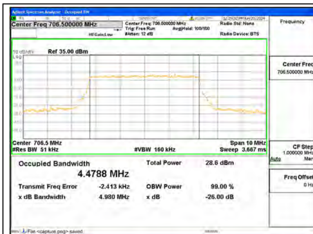
B17 / 5MHz / QPSK/ Low CH
