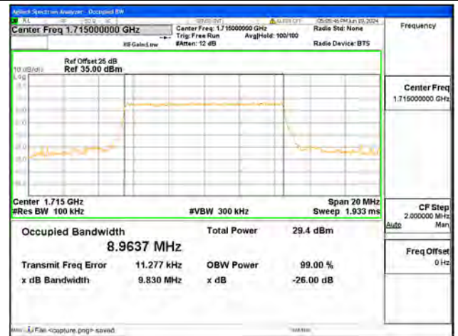
B66 / 10MHz / QPSK/ Low CH
