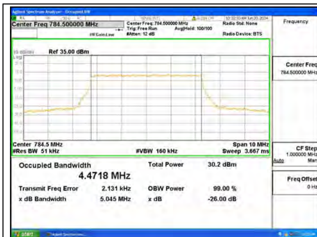
B13 / 5MHz / QPSK/ High CH
