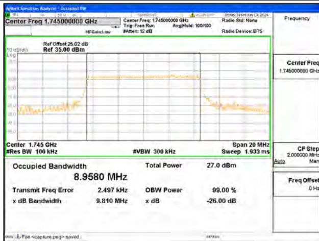
B66 / 10MHz / 64QAM/ Mid CH
