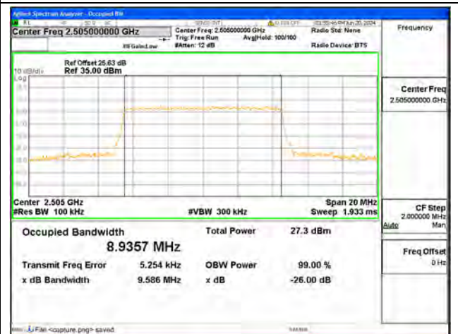
B7 / 10MHz / 64QAM/ Low CH
