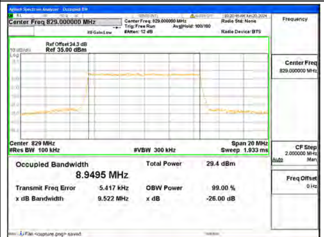
B5 / 10MHz / QPSK/ Low CH
