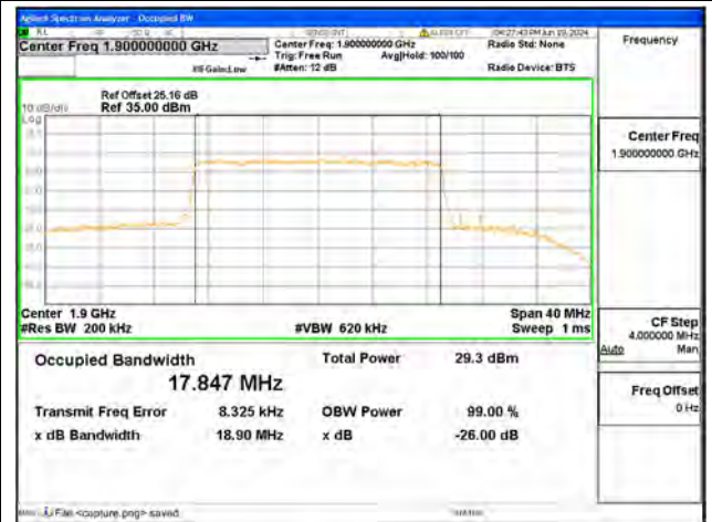
B2 / 20MHz / QPSK/ High CH
