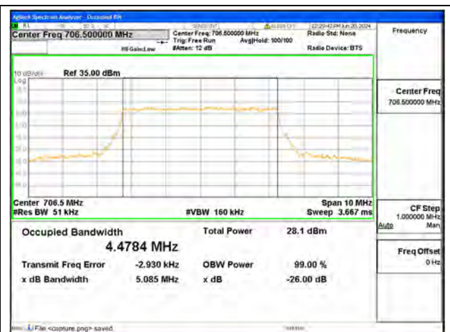
B17 / 5MHz / 16QAM/ Low CH
