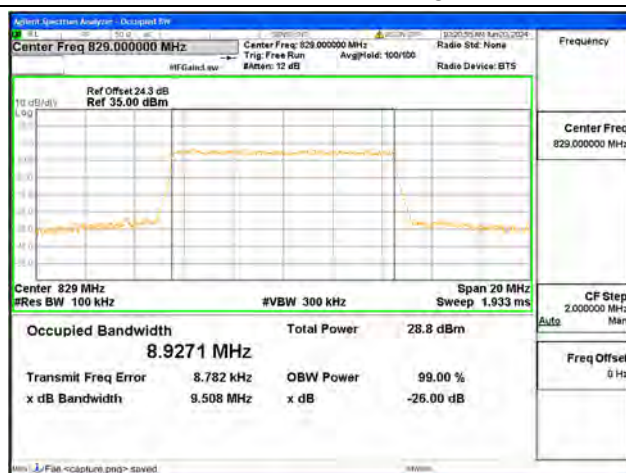
B5 / 10MHz / 16QAM/ Low CH
