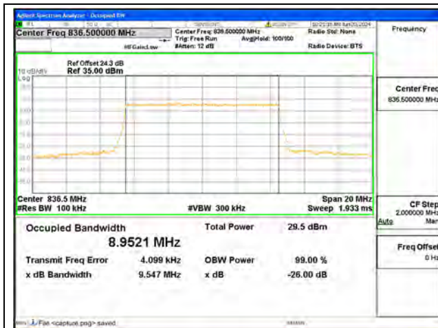
B5 / 10MHz / QPSK/ Mid CH
