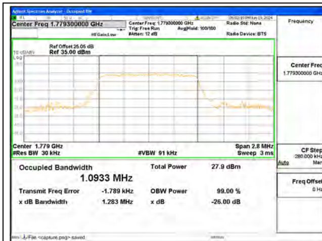
B66 / 1.4MHz / QPSK/ High CH
