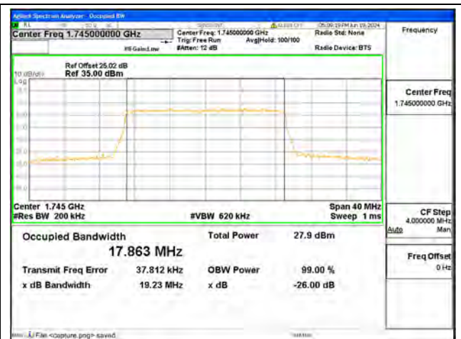
B66 / 20MHz / 16QAM/ Mid CH
