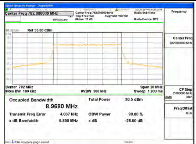
B13 / 10MHz / QPSK/ Mid CH
