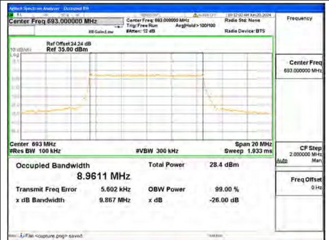
B71 / 10MHz / QPSK/ High CH
