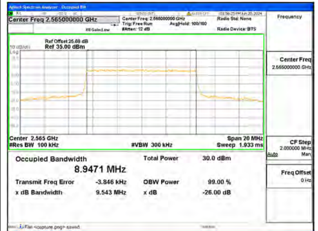
B7 / 10MHz / QPSK/ High CH
