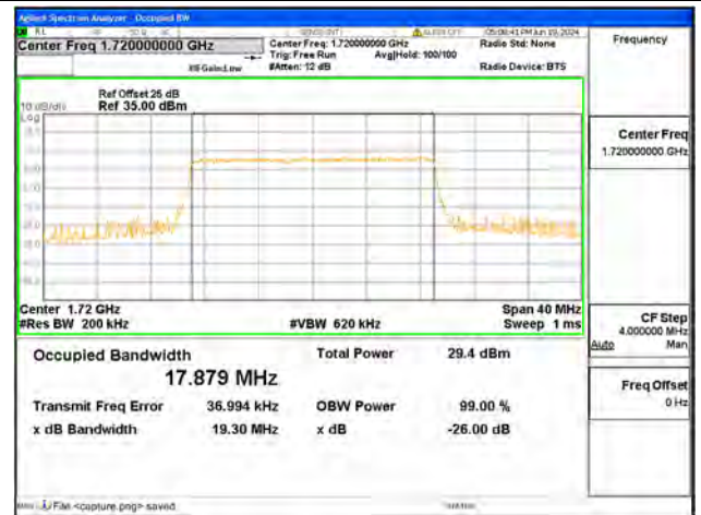
B66 / 20MHz / QPSK/ Low CH
