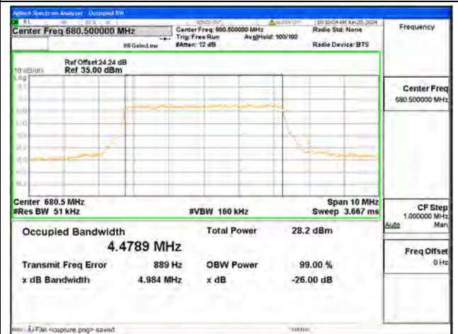
B71 / 5MHz / QPSK/ Mid CH
