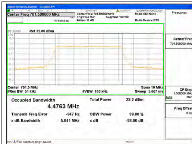
B12 / 5MHz / QPSK/ Low CH
