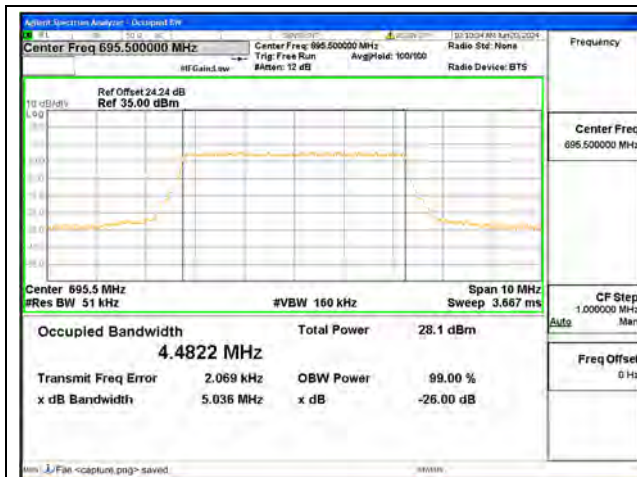
B71 / 5MHz / QPSK/ High CH
