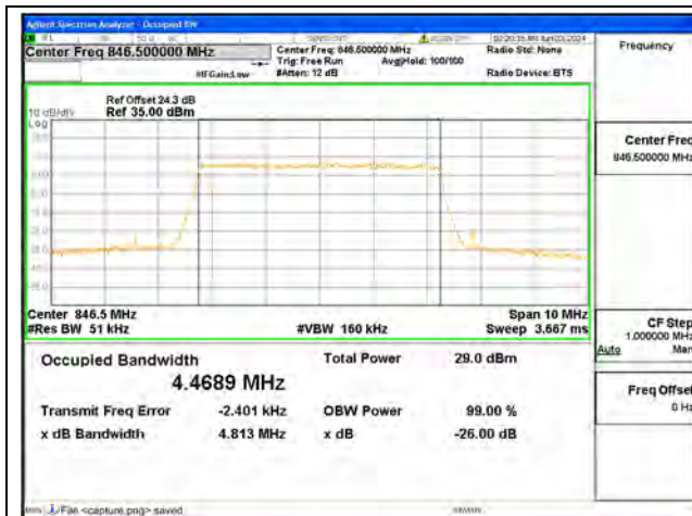
B5 / 5MHz / QPSK/ High CH
