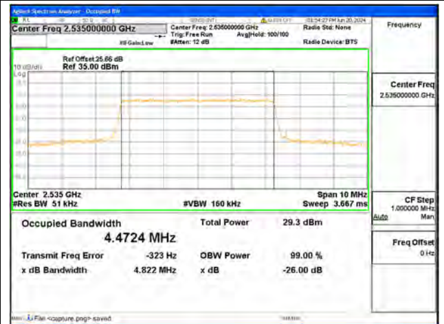
B7 / 5MHz / QPSK/ Mid CH
