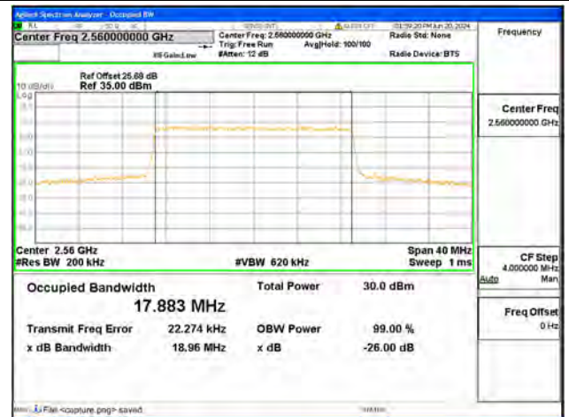
B7 / 20MHz / QPSK/ High CH
