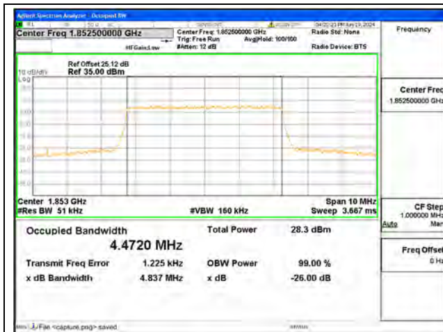
B2 / 5MHz / QPSK/ Low CH
