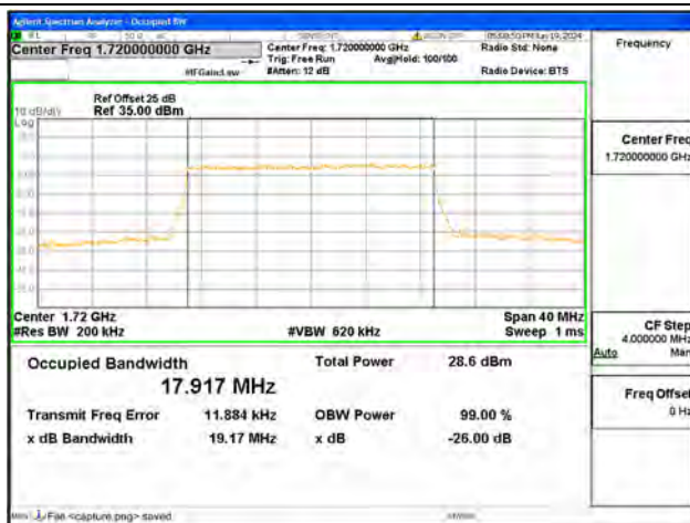
B66 / 20MHz / 16QAM/ Low CH
