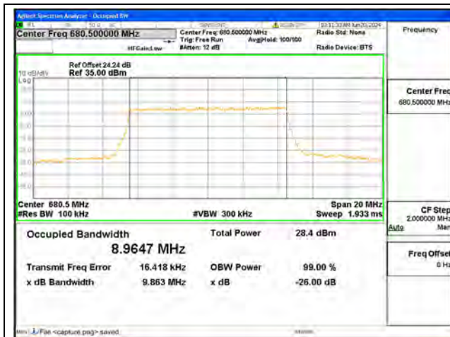
B71 / 10MHz / QPSK/ Mid CH
