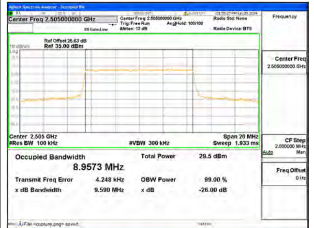
B7 / 10MHz / QPSK/ Low CH
