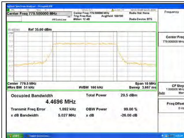
B13 / 5MHz / QPSK/ Low CH
