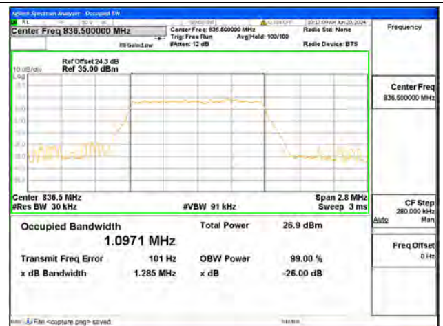
B5 / 1.4MHz / 64QAM/ Mid CH
