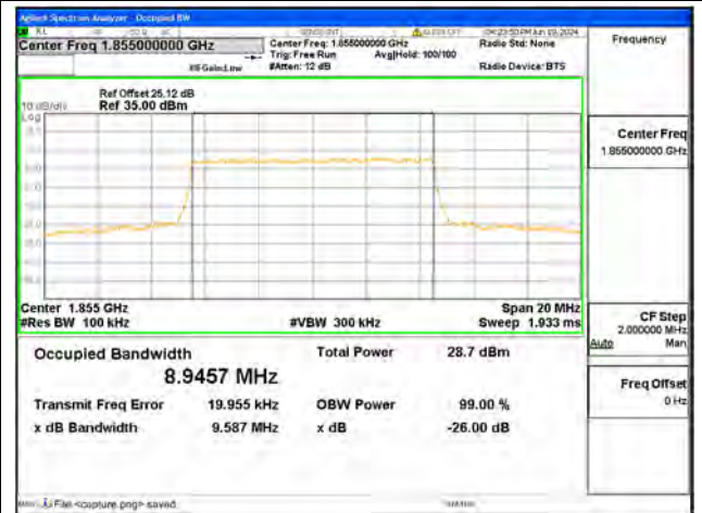
B2 / 10MHz / QPSK/ Low CH
