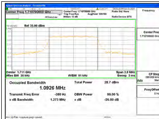
B66 / 1.4MHz / QPSK/ Low CH
