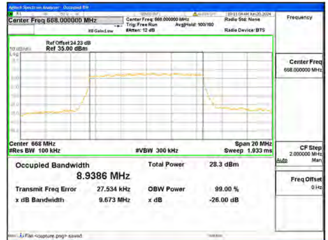
B71 / 10MHz / QPSK/ Low CH
