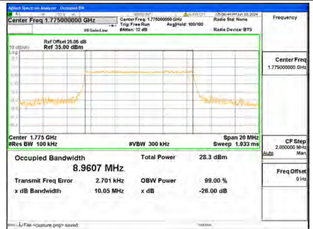
B66 / 10MHz / QPSK/ High CH
