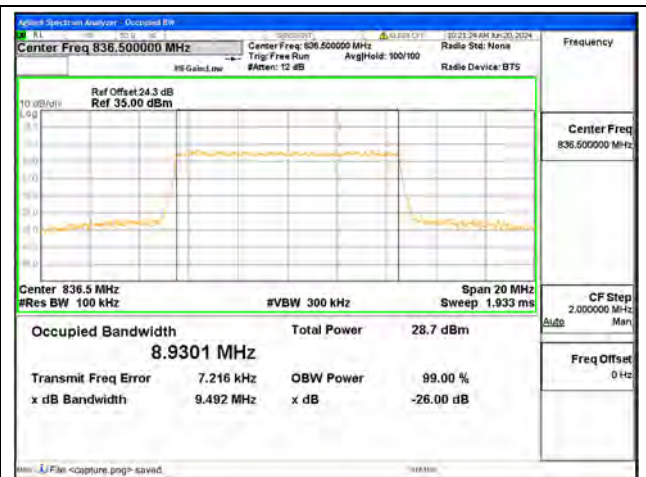
B5 / 10MHz / 16QAM/ Mid CH
