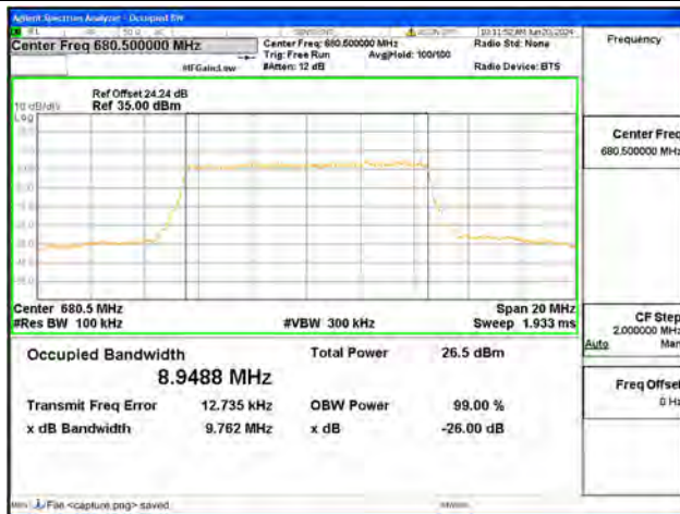
B71 / 10MHz / 64QAM/ Mid CH
