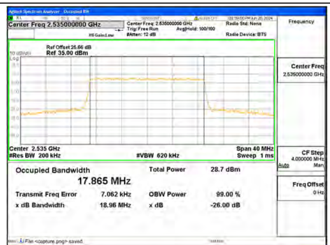
B7 / 20MHz / 16QAM/ Mid CH
