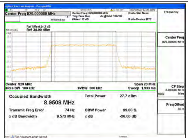
B5 / 10MHz / 64QAM/ Low CH
