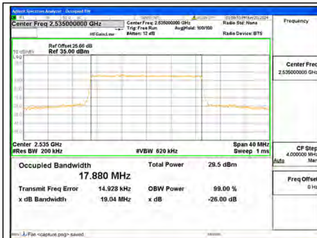
B7 / 20MHz / QPSK/ Mid CH
