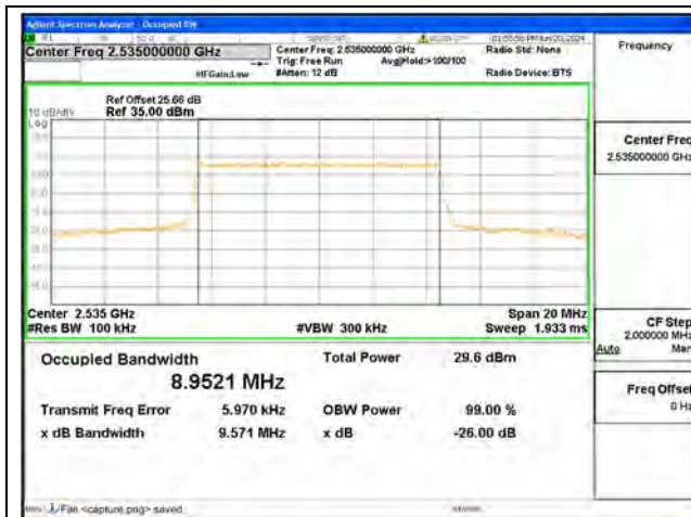
B7 / 10MHz / QPSK/ Mid CH
