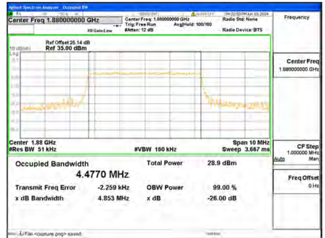
B2 / 5MHz / QPSK/ Mid CH
