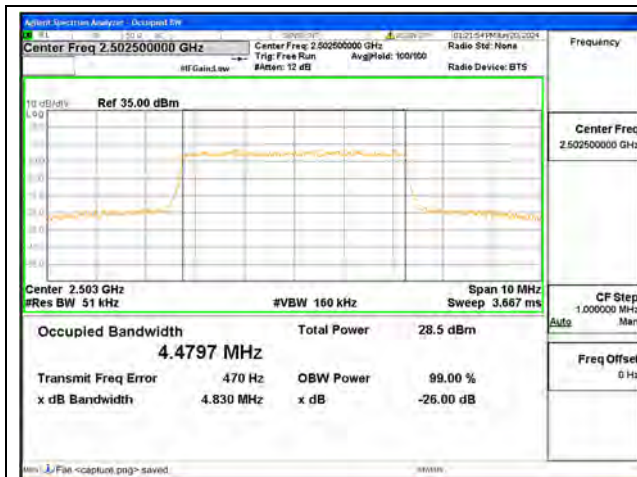
B7 / 5MHz / QPSK/ Low CH
