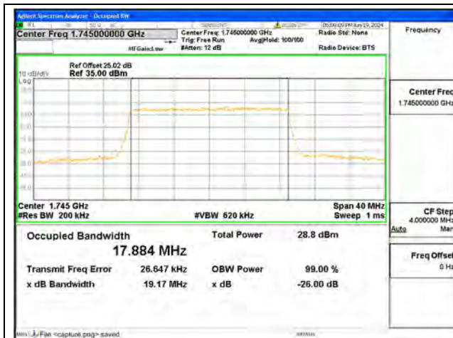
B66 / 20MHz / QPSK/ Mid CH
