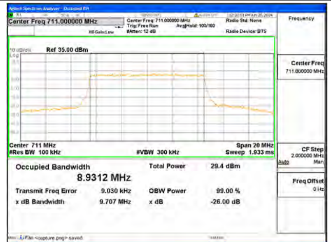
B17 / 10MHz / QPSK/ High CH
