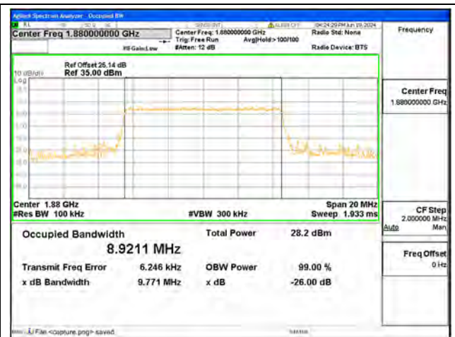
B2 / 10MHz / 16QAM/ Mid CH
