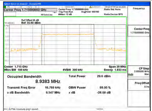
B4 / 10MHz / QPSK/ Low CH
