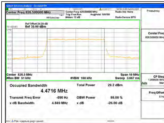
B5 / 5MHz / QPSK/ Low CH
