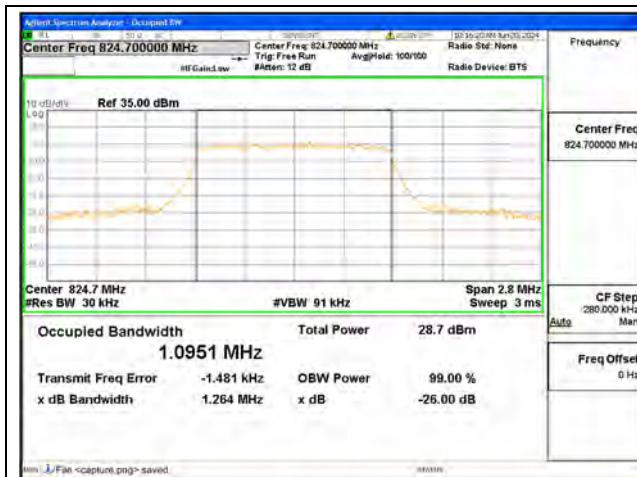
B5 / 1.4MHz / QPSK/ Low CH
