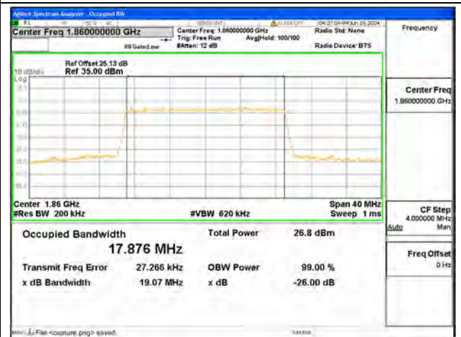
B2 / 20MHz / 64QAM/ Low CH
