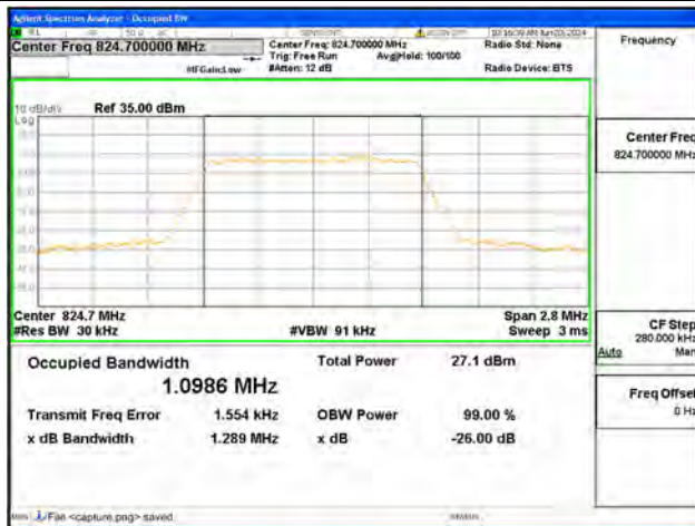
B5 / 1.4MHz / 64QAM/ Low CH
