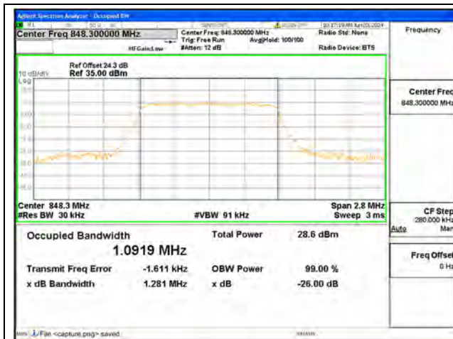
B5 / 1.4MHz / QPSK/ High CH
