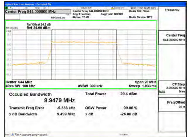
B5 / 10MHz / QPSK/ High CH
