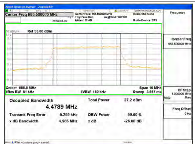
B71 / 5MHz / 16QAM/ Low CH
