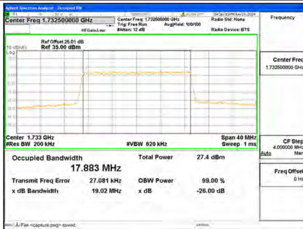
B4 / 20MHz / 64QAM/ Mid CH
