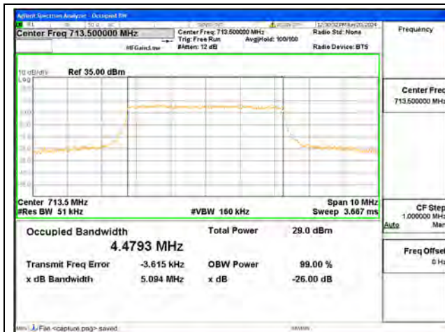
B17 / 5MHz / QPSK/ High CH
