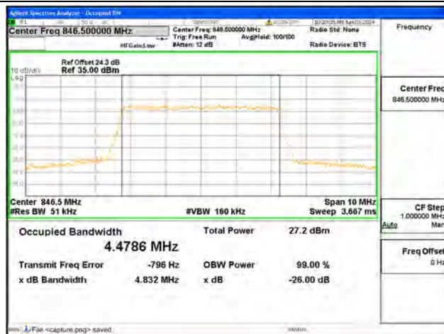
B5 / 5MHz / 64QAM/ High CH
