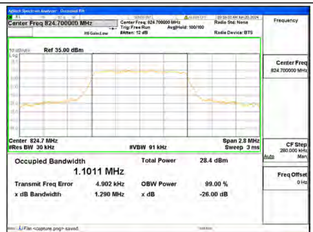
B5 / 1.4MHz / 16QAM/ Low CH
