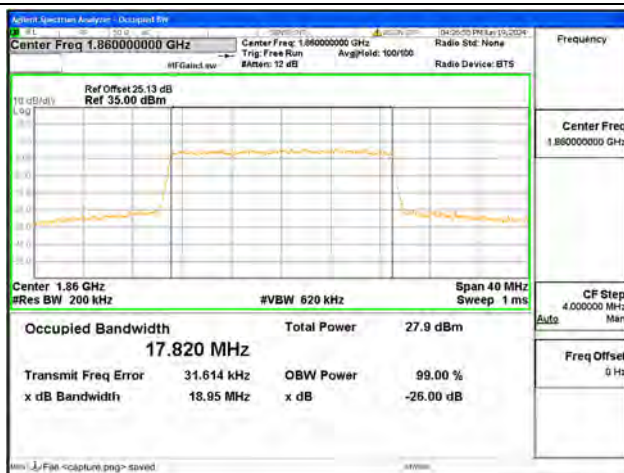
B2 / 20MHz / 16QAM/ Low CH
