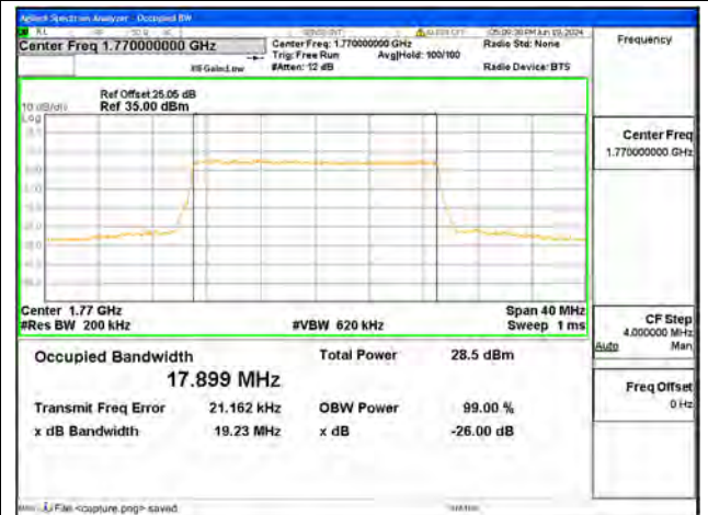
B66 / 20MHz / QPSK/ High CH
