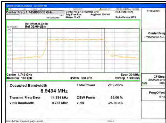
B66 / 10MHz / QPSK/ Mid CH
