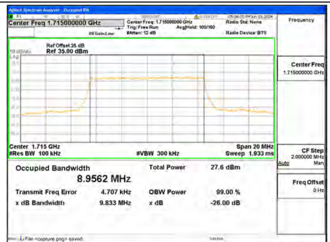
B66 / 10MHz / 64QAM/ Low CH
