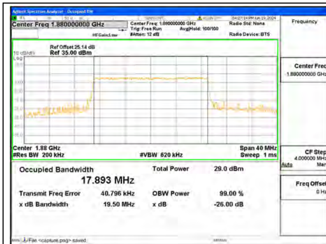
B2 / 20MHz / QPSK/ Mid CH
