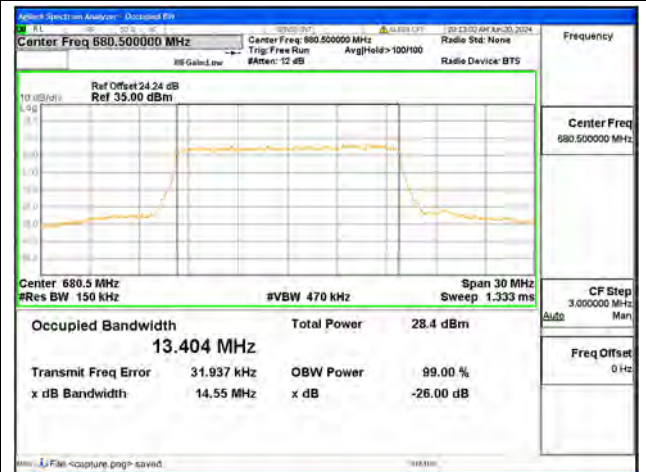
B71 / 15MHz / QPSK/ Mid CH
