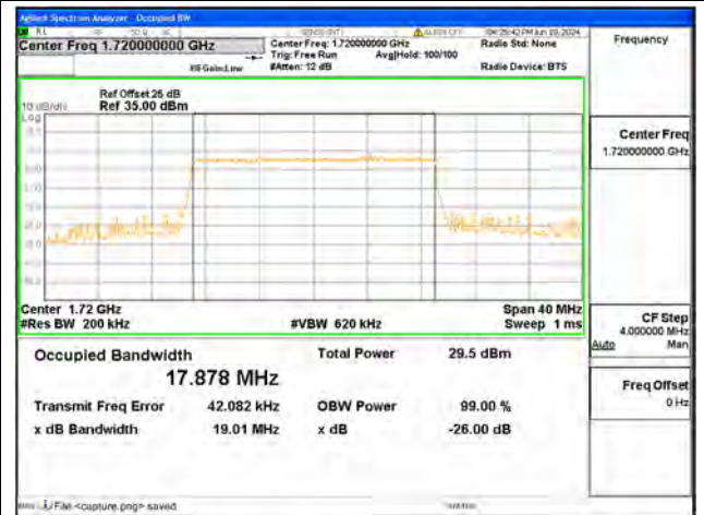
B4 / 20MHz / QPSK/ Low CH
