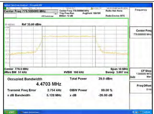
B13 / 5MHz / 16QAM/ Low CH
