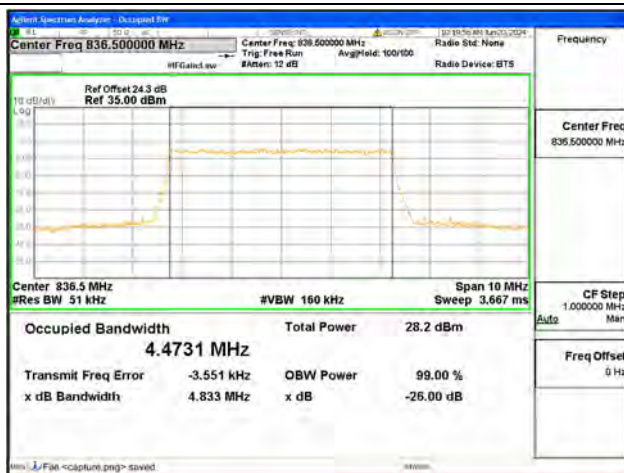
B5 / 5MHz / 16QAM/ Mid CH
