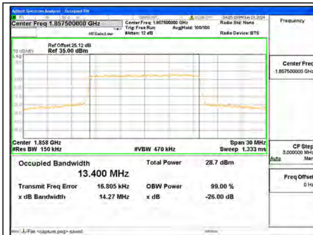
B2 / 15MHz / QPSK/ Low CH
