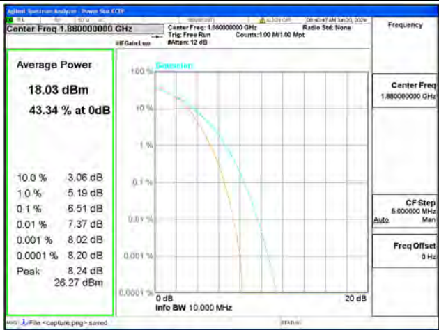
B2 / 10MHz / Mid CH / 64QAM
