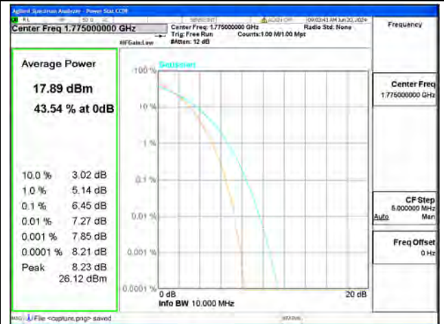
B66 / 10MHz / High CH / 64QAM
