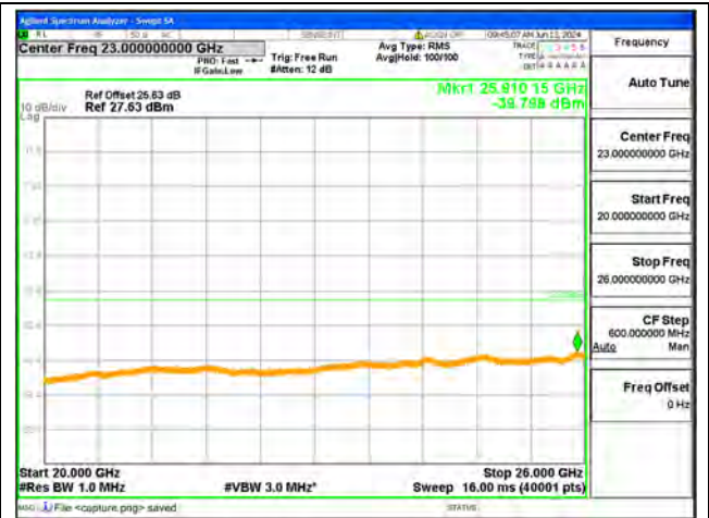
B7-20G-26G / 10MHz / Low CH / QPSK
