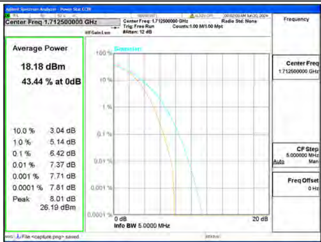
B66 / 5MHz / Low CH / 64QAM
