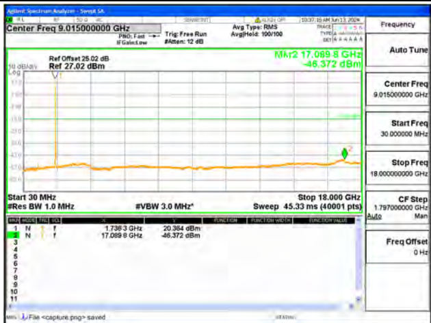
B66 / 20MHz / Mid CH / QPSK
