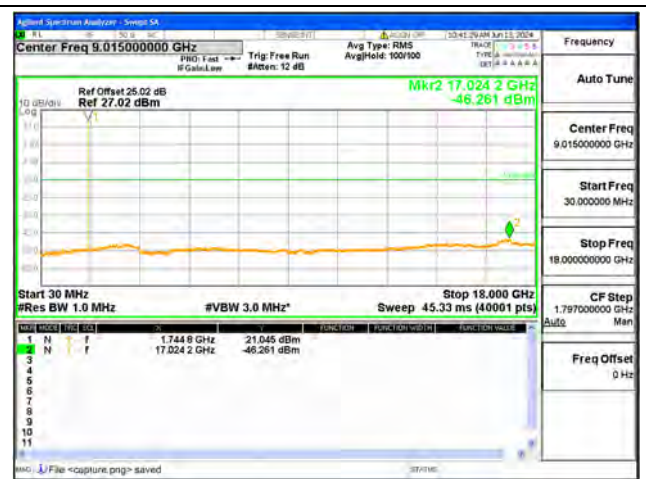
B66 / 1.4MHz / Mid CH / QPSK
