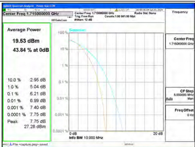
B4 / 10MHz / Low CH / 16QAM
