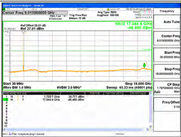
B4 / 20MHz / Mid CH / QPSK
