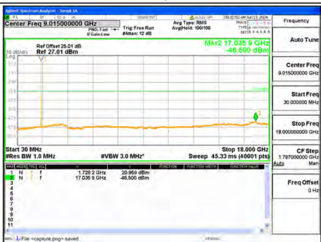
B4 / 10MHz / Mid CH / QPSK
