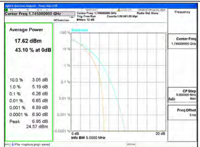
B66 / 1.4MHz / Mid CH / 64QAM
