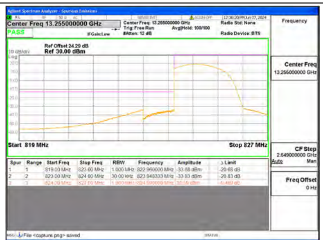
B5 / 1.4MHz / Low CH / QPSK / FULL RB
