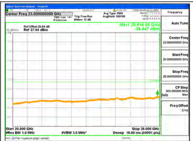
B7-20G-26G / 20MHz / Low CH / QPSK
