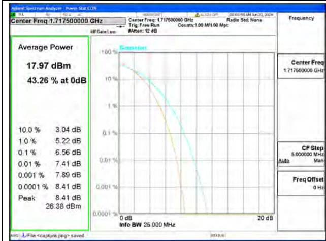
B66 / 15MHz / Low CH / 64QAM
