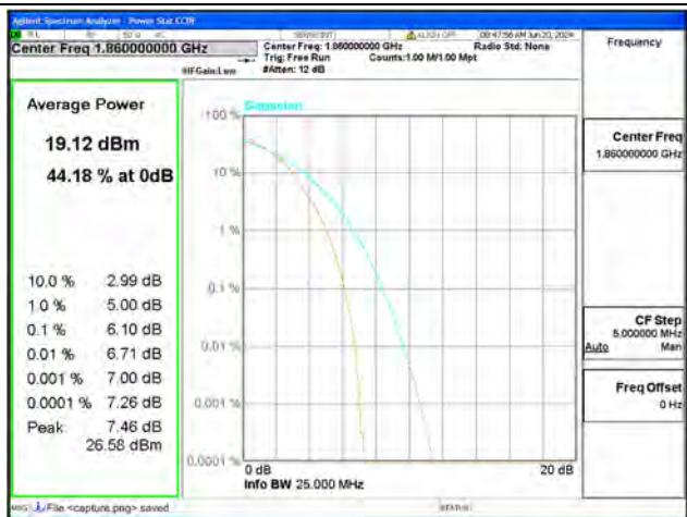
B2 / 20MHz / Low CH / 16QAM
