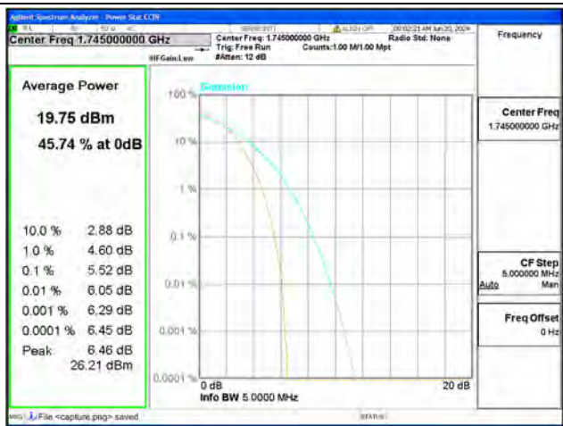
B66 / 5MHz / Mid CH / 16QAM
