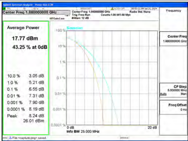
B2 / 20MHz / Mid CH / 64QAM
