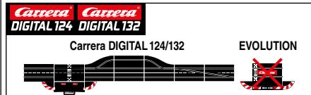
Respektujte skutočnosť, že Evolution (analógový systém) a Carrera DIGITAL 124/132 (digitálny systém) sú dva samostatné a úplne nezávislé systémy. Carrera WIRELESS 2.0 sa dá použiť iba pre Carrera Digital 124 a Digital 132.
