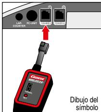
Conecte el Receptor WIRELESS 2.0 siguiendo los símbolos correspondientes en una de las dos tomas de la Unidad de Control, designadas como Tower 1 y Tower 2. El Receptor puede conectarle indistintamente a la Black Box 20030344 o la Unidad de Control 20030352. Un único Receptor WIRELESS 2.0 permite conectar hasta 6 controladores WIRELESS 2.0.
