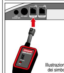
Collegare il ricevitore WIRELESS 2.0 a una delle due prese della Control Unit indicate come Tower 1 e Tower 2, come mostrato nella figura. Non è necessario che il ricevitore sia collegato alla Black Box 20030344 o alla Control Unit 20030352. Occorre un solo ricevitore WIRELESS 2.0 per far funzionare fino a 6 controller manuali WIRELESS 2.0.
