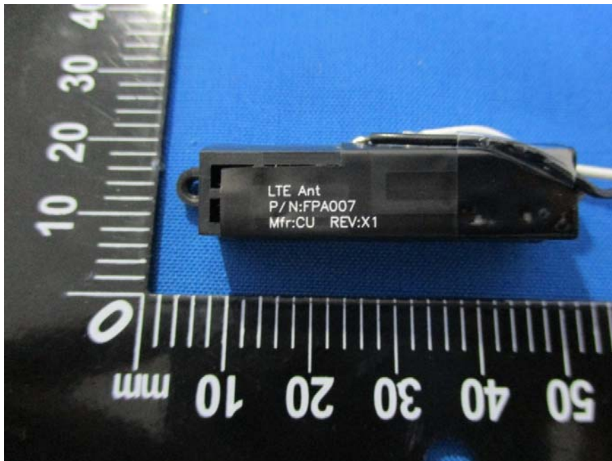
EUT -LTE Aux Antenna View
