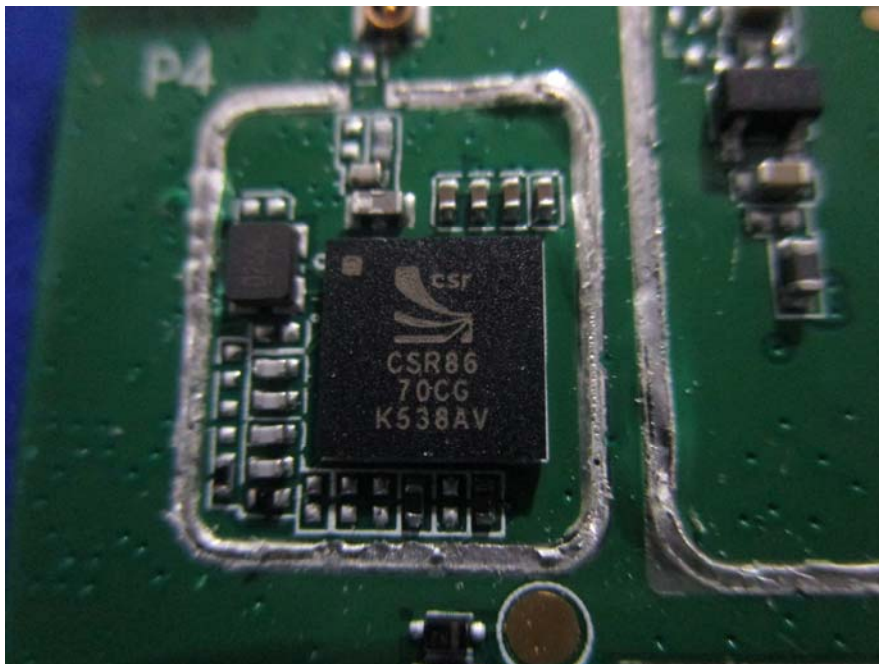
EUT –BT Chip View
