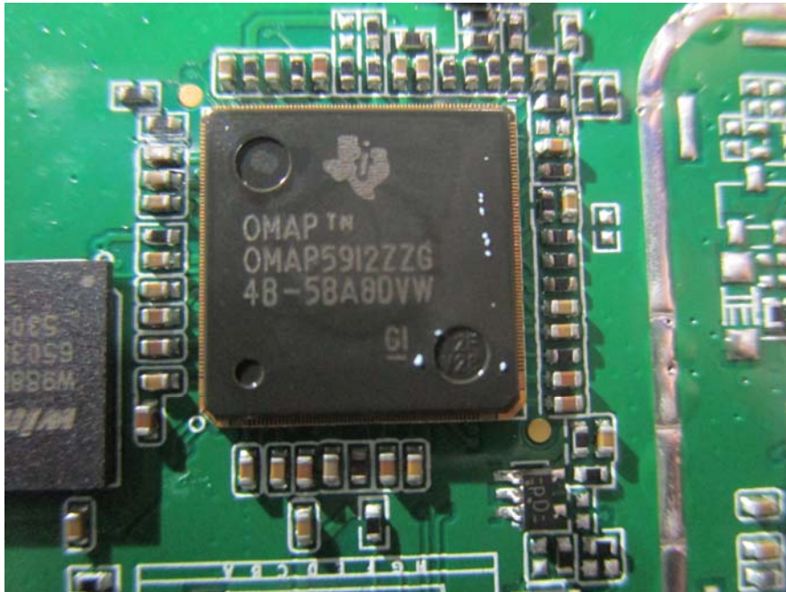
EUT –BT Chip View
