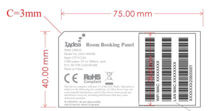
直接印刷mark框,框内贴附SN LABEL
