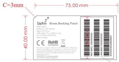
直接印刷mark框,框内贴附SN LABEL
