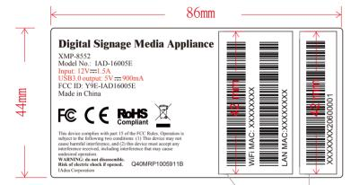
直接印刷mark框,框内贴附SNIabel(42x10mm) 直接印刷mark框,框内贴附MAC label(42x20mm)
