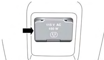
Onduleur d'alimentation de 115 V
