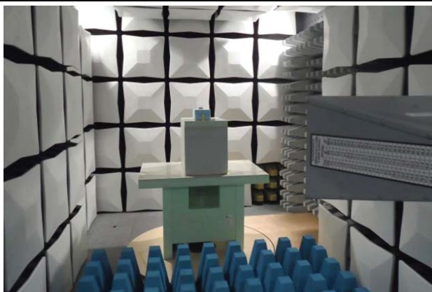
Figure 18: Measurement of unwanted emissions < 16 GHz [Messung von unerwünschten Aussendungen < 16 GHz]
